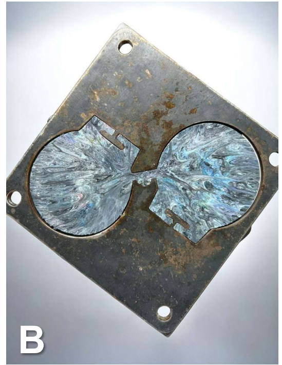
Figura 4. Da matéria-prima à reciclagem: (A) Tampas de plástico arrecadadas pelos alunos e (B) Plástico injetado no molde em formato de medalha.
