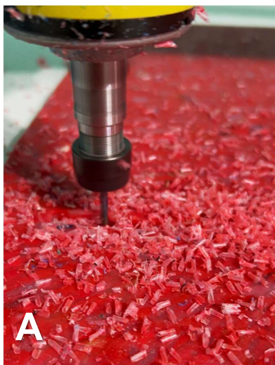
Figura 4. Etapa final do processo de reciclagem mecânica: (A) Fresadora CNC realizando o corte (B) Handboard finalizada.
