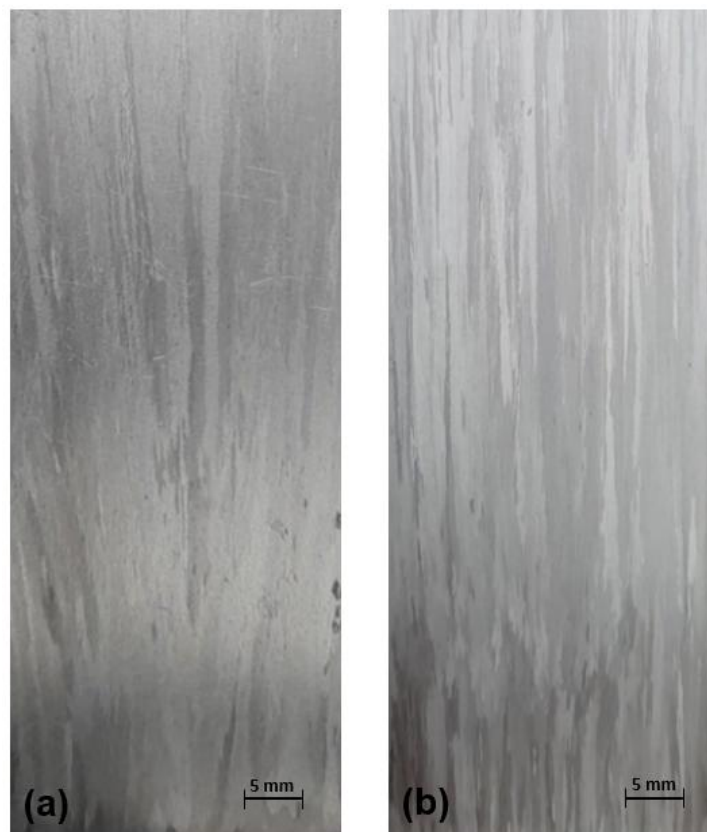
Figura 54 – Macroestruturas das ligas (a) Al-5%Zn-0,5%Fe; (b) Al-5%Zn-1,5%Fe.
