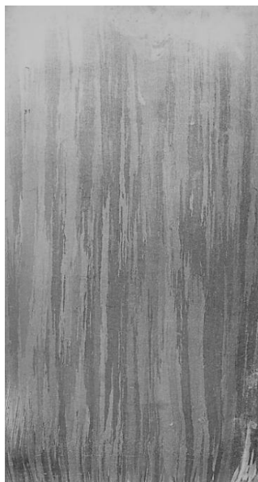
Figura 10 – Macrografia da liga Al-20%Zn-2%Bi. Ataque HF 1% Fonte: Travassos Junior, 2021
