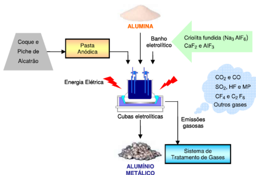
Figura 3 – Esquema simplificado do processo Hall-Héroult
