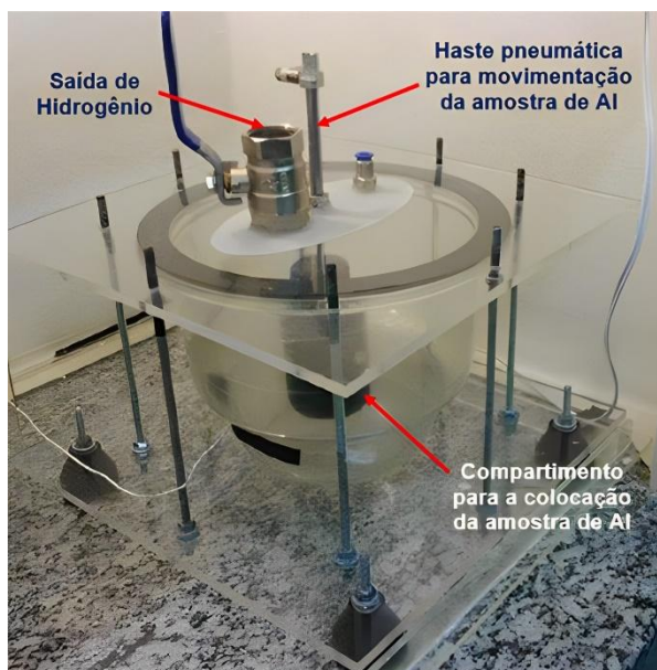
Figura 26 – Reator de Cassanelli Fonte: Cassanelli, 2016 (modificado).
