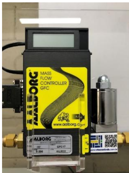
Figura 36 – Medidor de vazão de hidrogênio
