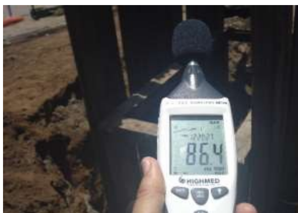
Fotos 03 e 04 – A primeira foto retrata a medição do ruído onde foi realizada a vistoria, enquanto a segunda foto retrata a retroescavadeira retirando a terra para fazer o escoramento.
