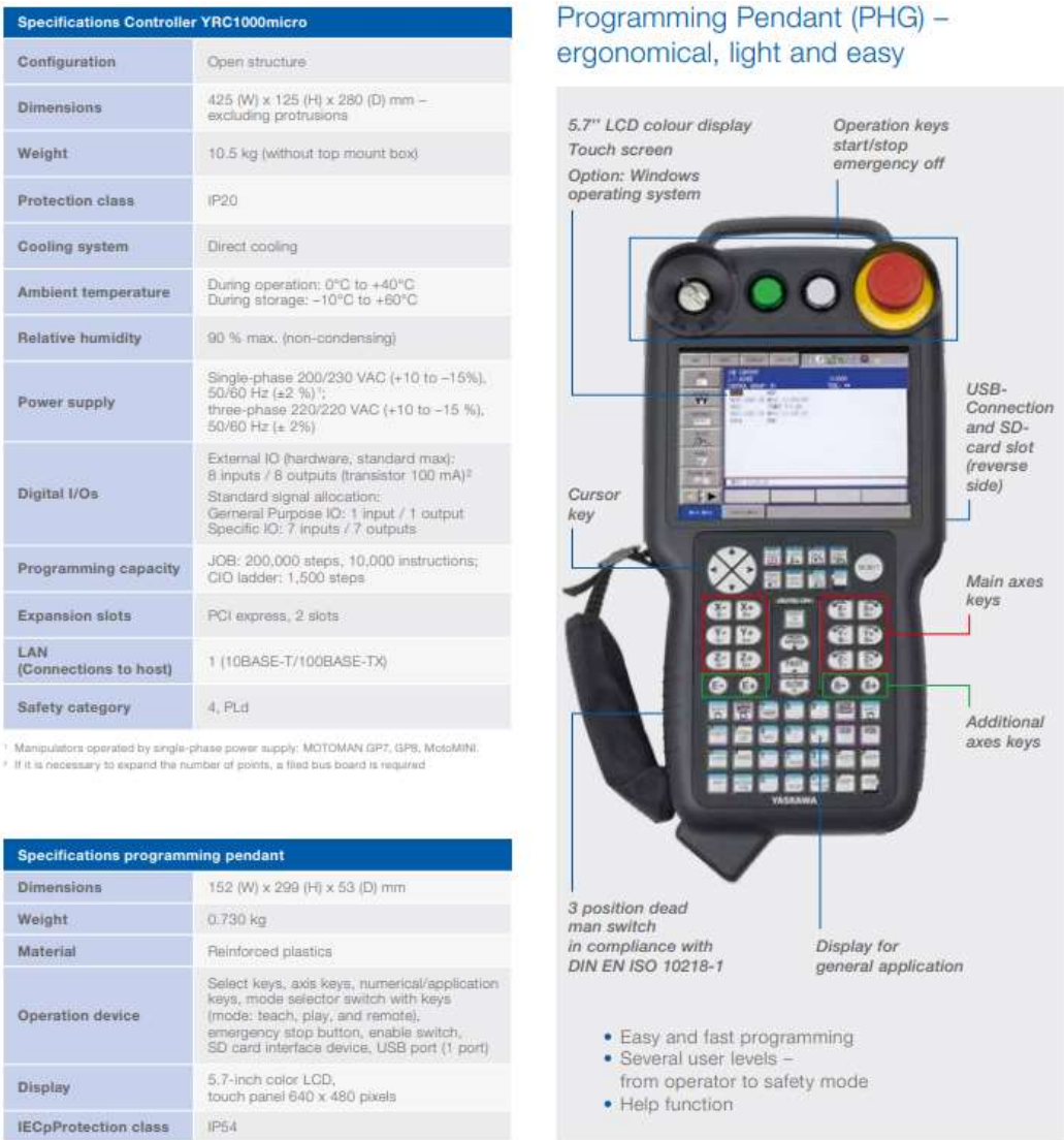
Figura 18 - Características do Smart Pendant do Controlador YRC1000micro. Fonte: Manual YASKAWA MOTOMAN – GP8
