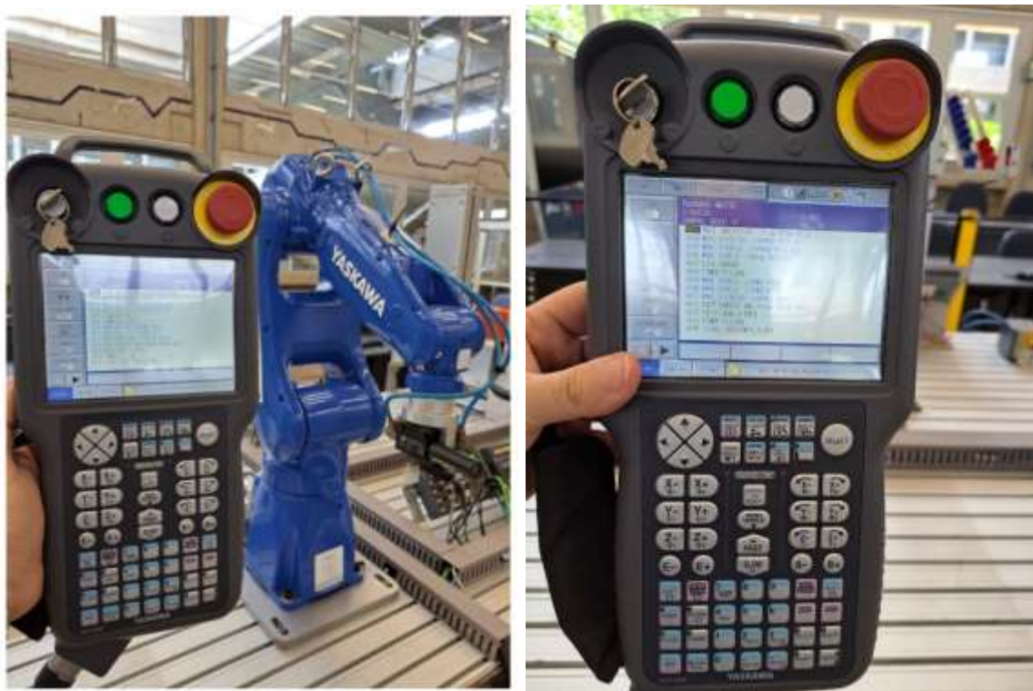
Figura 14 - Robô YASKAWA modelo MOTOMAN GP8 e seu Teach Pendant .
