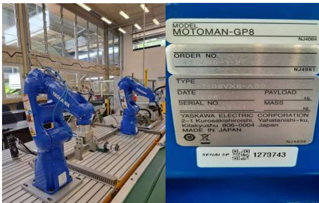
Figura 13 - OpenLab e robô YASKAWA modelo MOTOMAN GP8 com placa de dados de suas características.
