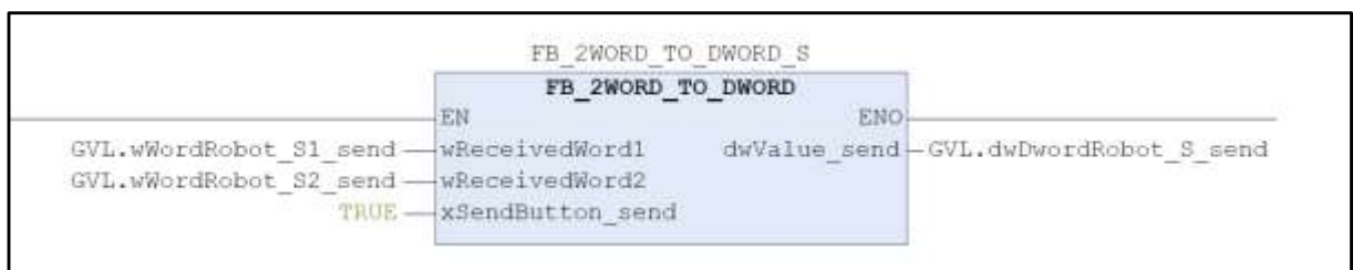
Figura 56 - Bloco Funcional FB_2WORD_TO_DWORDS_X.
