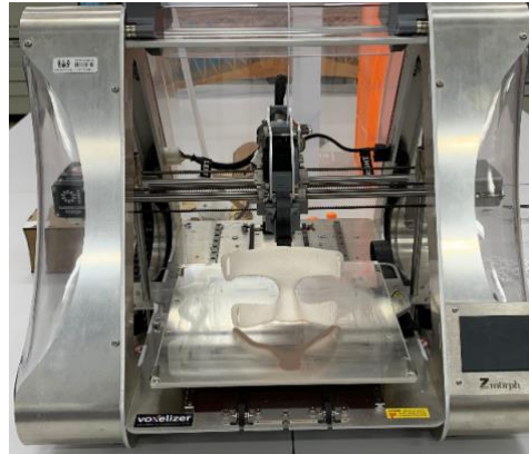
Figura 4: Protetor Facial Digital Impresso (vista frontal) em Impressora 3D Zmorph VX
