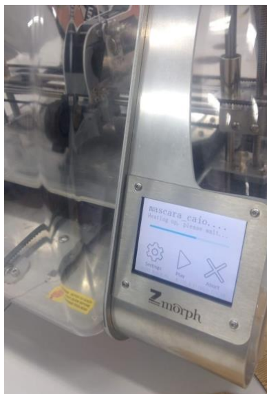
Figura 5: Impressora 3D Zmorph VX em processo de impressão
