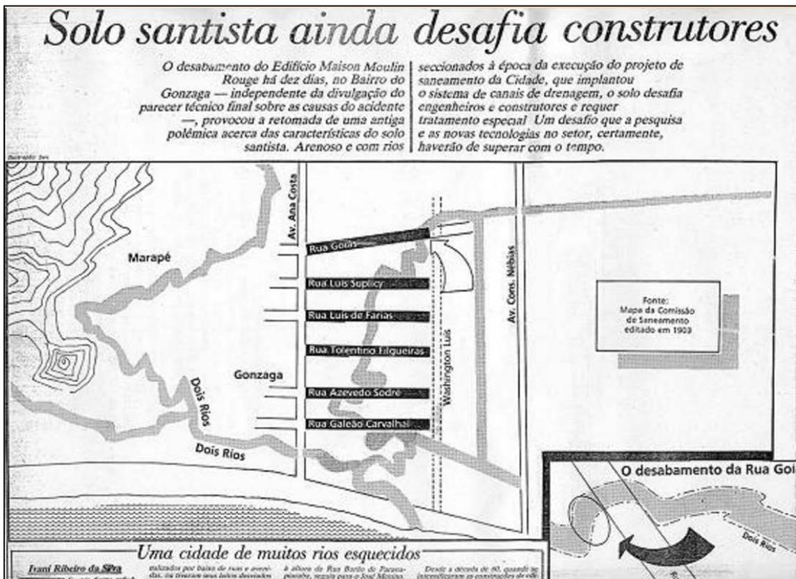
**Figura 16 – Leito do riacho esquecido, sobre o qual ocorreu o desmoronamento de um edifício durante sua construção.**
