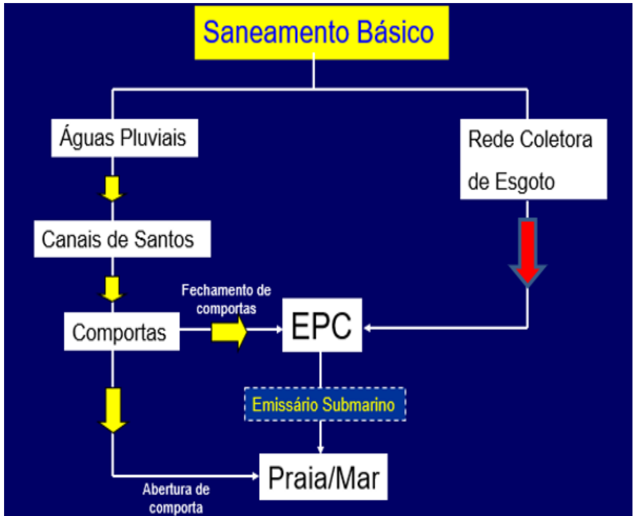
Figura 21. Sistema separador absoluto das águas pluviais e esgoto. Modelo teórico proposto por Brito com as complementações nas décadas posteriores.
