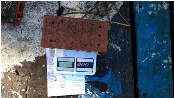
**Figura 16 - Peso inicial de placa de cerâmica sem tratamento para utilizar como parâmetro de placa molhada.**
