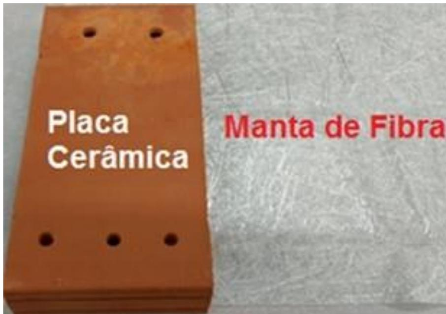
Figura 4 - Manta de fibra de vidro a ser aderida na placa de cerâmica.
