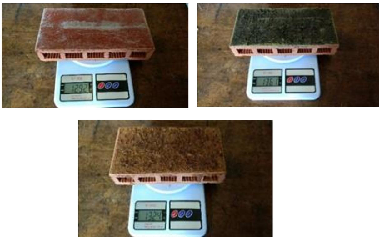
Figura 19 - Peso inicial Bertioga. RES= placa de cerâmica revestida por tratamento de Resina; TER= placa de cerâmica revestida com *T. catappa*; MUSA= placa de cerâmica revestida com tratamento de *Musa* sp.
