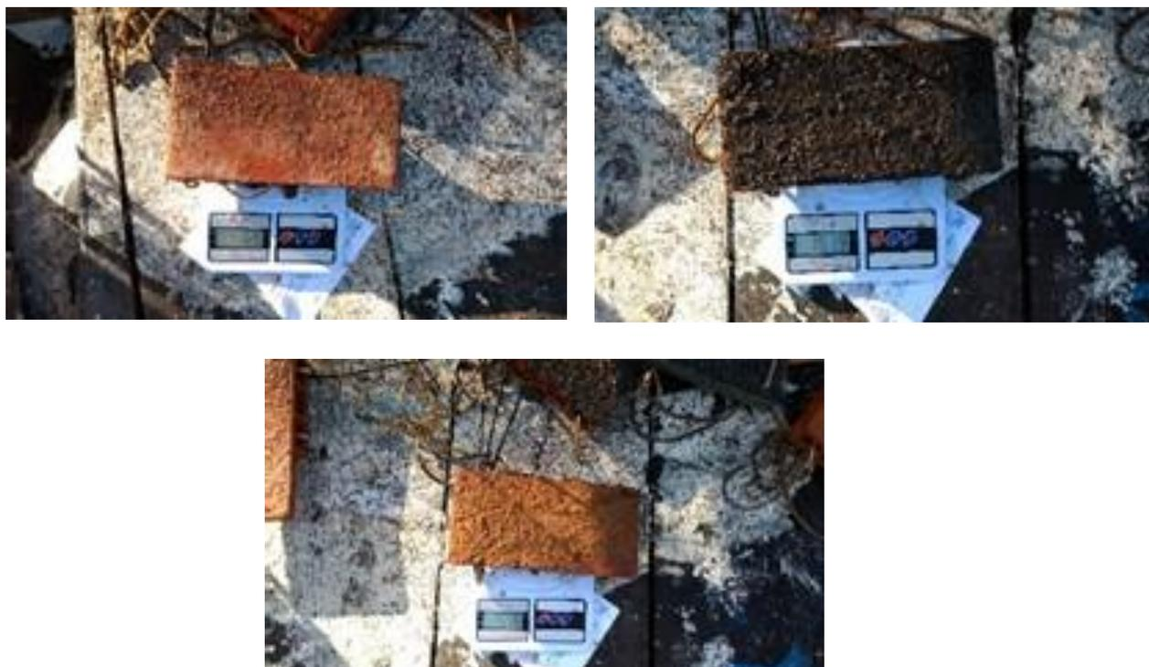
Figura 20 - 1ª coleta Bertioga. RES= placa de cerâmica revestida por tratamento de Resina; TER= placa de cerâmica revestida com *T. catappa*; MUSA= placa de cerâmica revestida com tratamento de *Musa* sp.
