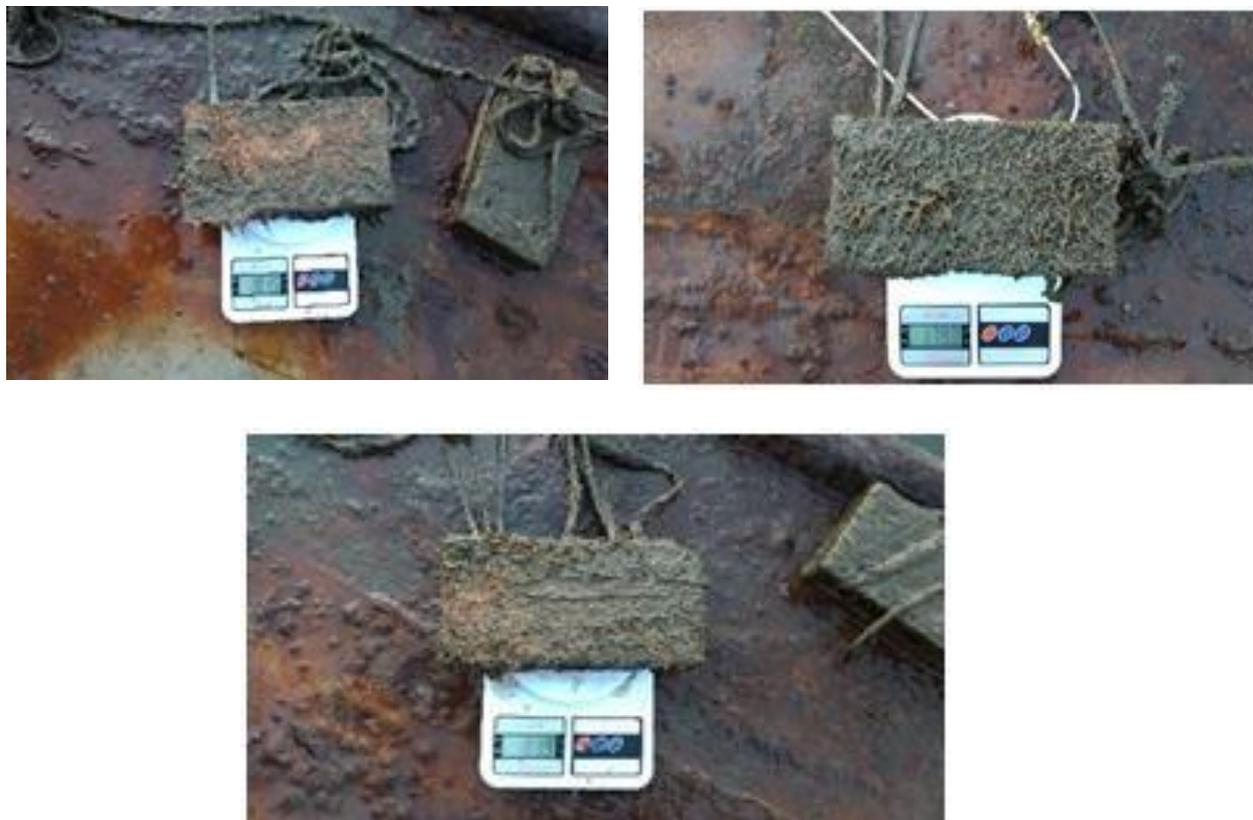
Figura 18 - 1ª coleta Guarujá. RES= placa de cerâmica revestida por tratamento de Resina; TER= placa de cerâmica revestida com *T. catappa*; MUSA= placa de cerâmica revestida com tratamento de *Musa* sp.
