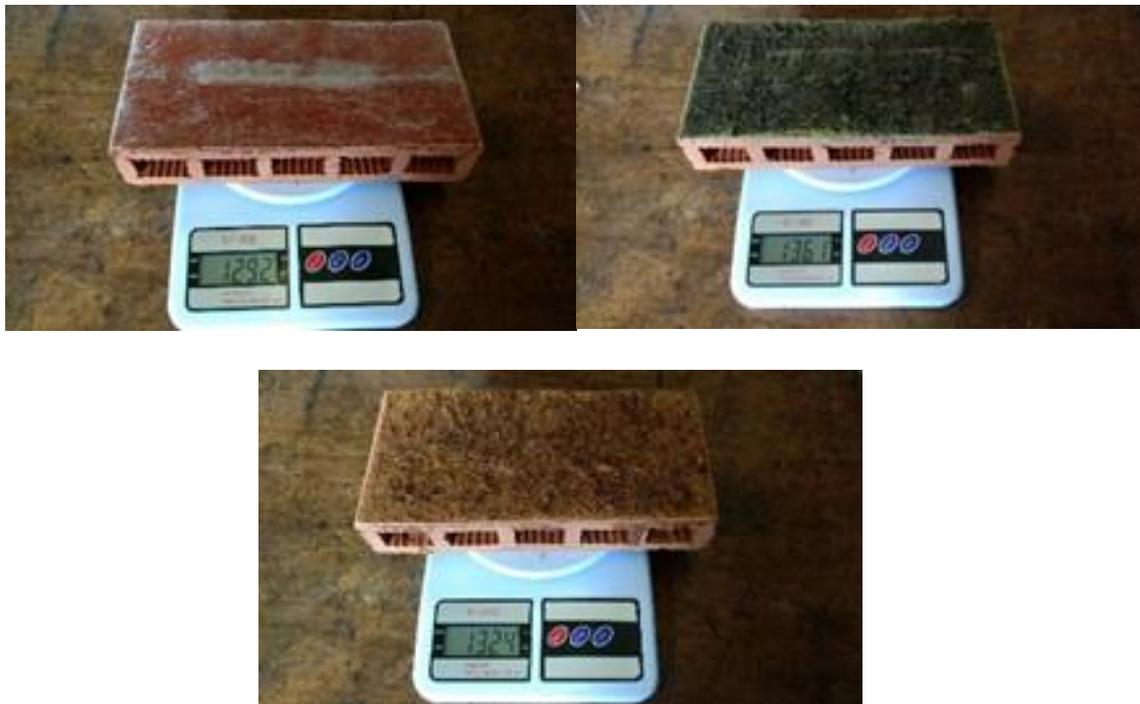
Figura 21 - Peso inicial São Vicente. RES= placa de cerâmica revestida por tratamento de Resina; TER= placa de cerâmica revestida com *T. catappa*; MUSA= placa de cerâmica revestida com tratamento de *Musa sp.*
