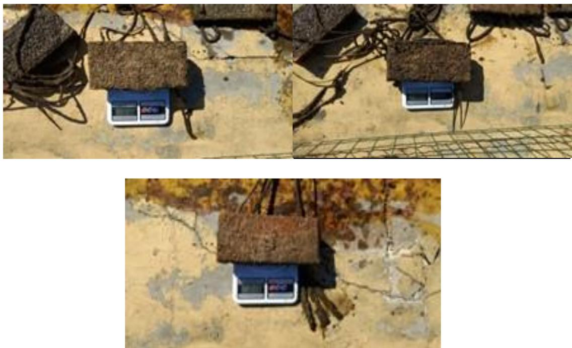
**Figura 22 - 1ª coleta São Vicente. RES= placa de cerâmica revestida por Tratamento de Resina; TER= cerâmica revestida com *T. catappa*; MUSA= cerâmica revestida com tratamento de *Musa* sp.**
