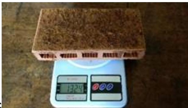
Figura 17 - Peso inicial Guarujá. RES= placa de cerâmica revestida por tratamento de Resina (A); TER= placa de cerâmica revestida com *T. catappa* (B); MUSA (C) = placa de cerâmica revestida com tratamento de *Musa* sp.
