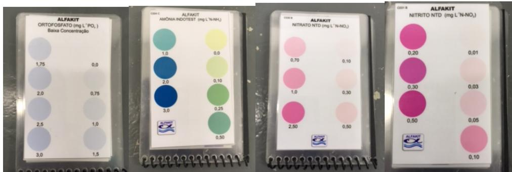
Figura 12 – Tabelas de cores utilizadas nos testes nos testes de ortofosfato, amônia, nitrato e nitrito.
