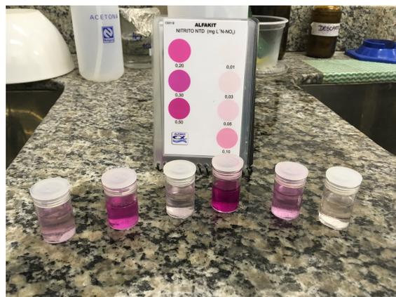
Figura 11 – Misturas das amostras com reagentes para teste de nitrito e tabela de cores.
