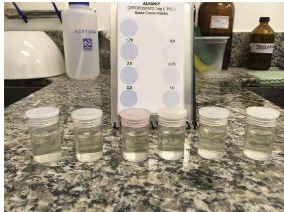
**Figura 9 – Misturas das amostras com reagentes para teste de ortofosfato e tabela de cores.**
