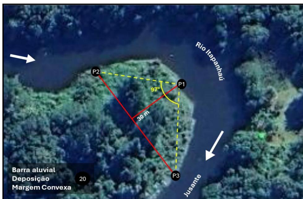
Figura 2 – Polígono para análise e determinação da curvatura em barra aluvial ao longo do rio Itapanhaú (Bertioga, SP)
