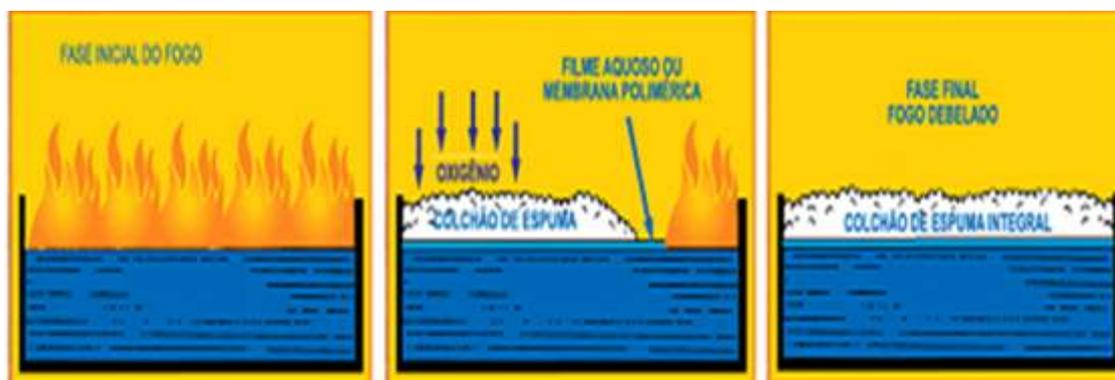
**Figura 3- Esquema de funcionamento LGE-AFFF na extinção de incêndio**
