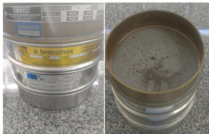
Figura 17. Jogo de peneiras para tamisação do sedimento utilizadas na análise das amostras do lodo do manguezal.
