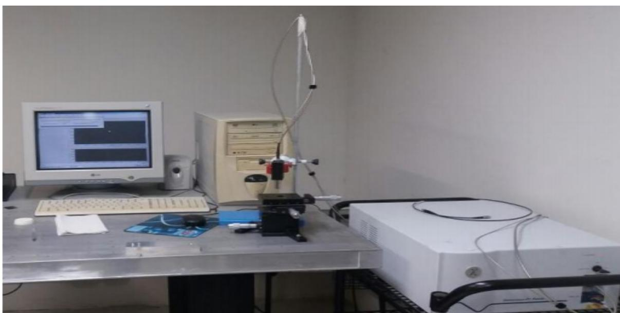
Figura 22. Sistema Raman dispersivo portátil utilizado no estudo.
