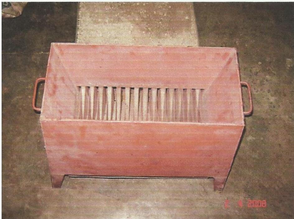
Figura 9 – Aparelho de quarteamento (quarteador).
