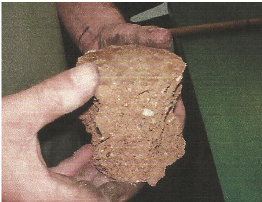
Figura 22 - Lajota de resíduo de demolição após o ensaio de ruptura.
