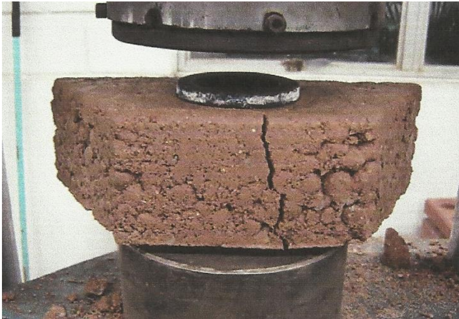
Figura 21 - Lajota de resíduo de demolição após o ensaio de ruptura onde podemos constatar a presença de vazios, e ruptura na vertical.
