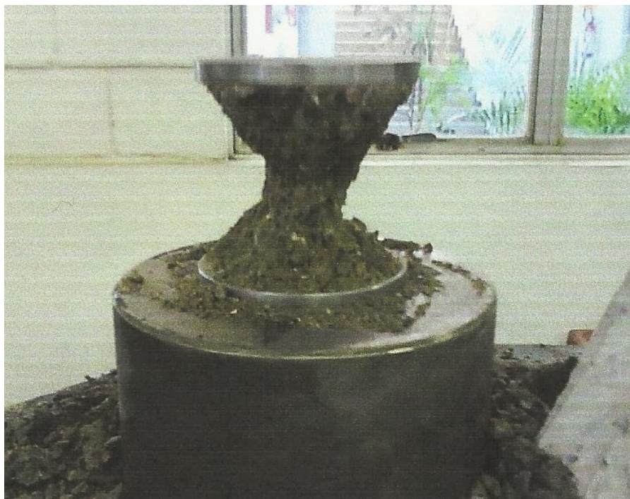
Figura 24 – Lajota após o ensaio, com a formação do cone de ruptura, que demonstra maneira correta da ruptura do corpo de prova (NBR 5739).
