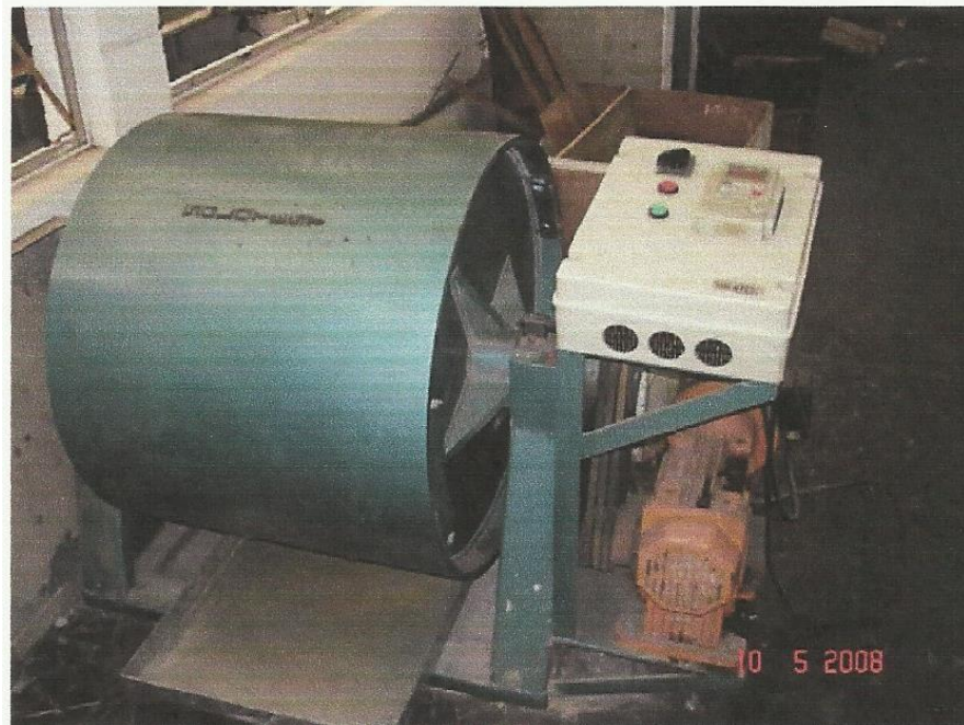
Figura 5 – Aparelho Los Angeles, moinho de bolas, que foi utilizado como triturador.
