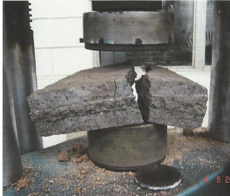
Figura 20 - Lajota de resíduo de demolição após o ensaio de ruptura a compressão.
