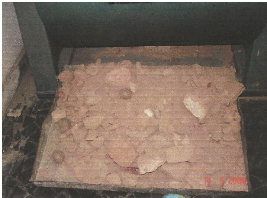
Figura 6 – Residuo de construção após a trituração no Los Angeles.
