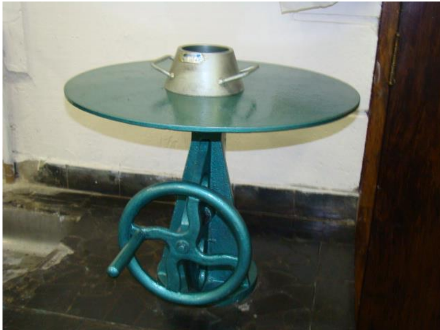
Figura 17 - Mesa de determinação da consistência “flow table”.
