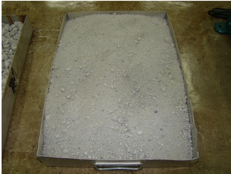
Figura 13 – Agregado miúdo de resíduo de obra obtido em usina de processamento. com granulometria definida.
