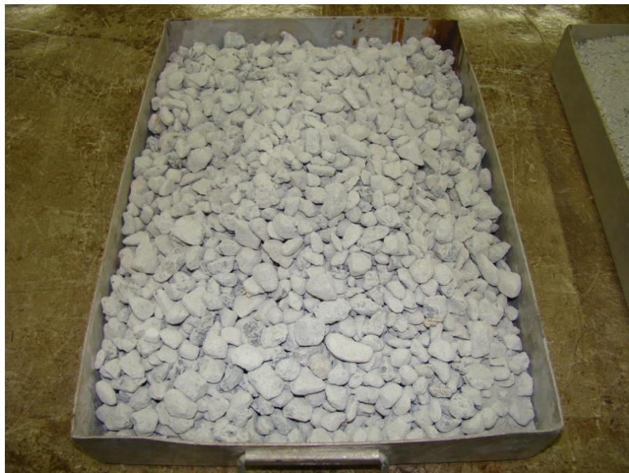
Figura 14 – Agregado graúdo de resíduo de obra obtido em usina de processamento. com granulometria definida.
