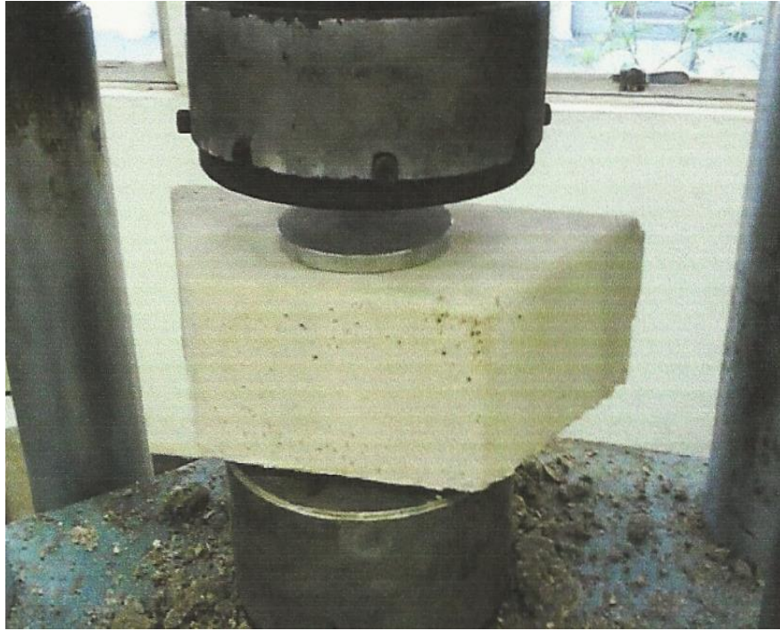
Figura 23 - Lajota de resíduo usinado do fabricante após o ensaio de ruptura.
