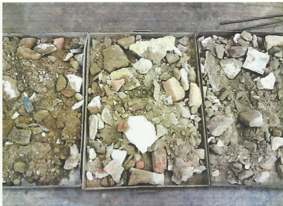
Figura 4 – Resíduo demolição de obra residencial no estado inicial
