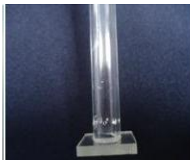
Figura 20: Difusor para dissolução do gás carbônico em água.
