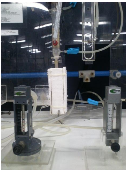
Figura 18: Bancada de ensaio desenvolvida no Laboratório de Operações Unitárias, para determinação de quantidade de dióxido de carbono adsorvida pelo RCD.
