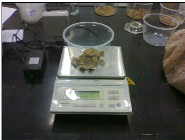
Figura 7. Pesagem do sedimento controle para serem empregados nos ensaios de toxicidade.
