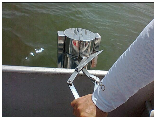
Figura 13. Coleta de sedimento utilizando o pegador de fundo do tipo van Veen .
