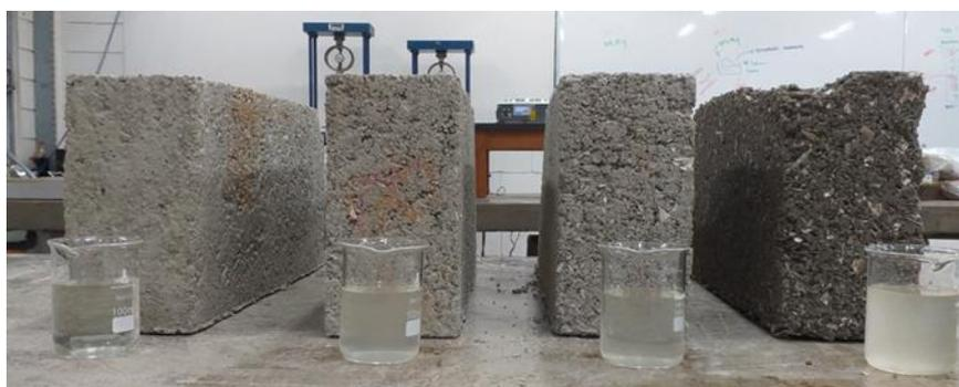
Figura 53: Figura dos modelos e das amostras com aumento da porcentagem de plástico: Bloco sem plástico, bloco com 5% de plástico, bloco com 10% de plástico e bloco com substituição de pedrisco por plástico.
