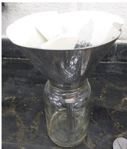
Figura 22: Figura do processo de filtragem e separação do líquido.
