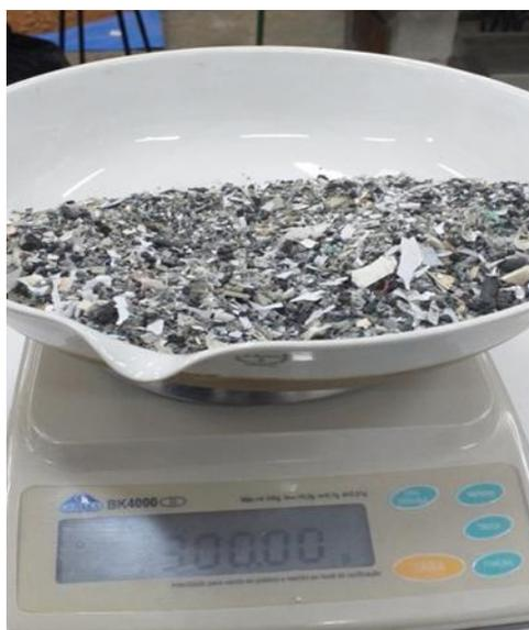
Figura 28: Figura do material sendo separado em 300gr para ensaio de granulometria.
