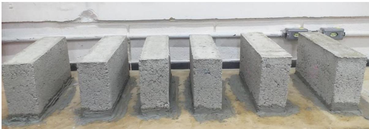
Figura 43: Figura dos 6 blocos capeados e nivelados.
