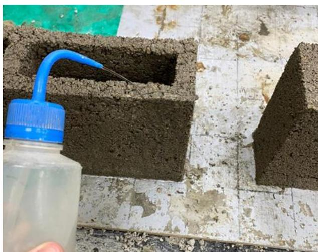
Figura 33: Figura do processo de molhagem do bloco na Universidade.
