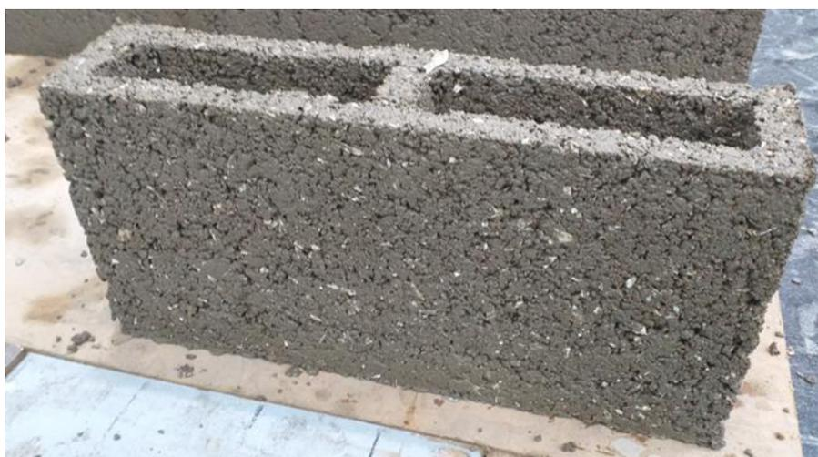
Figura 36: Figura do bloco com 5% de plástico.
