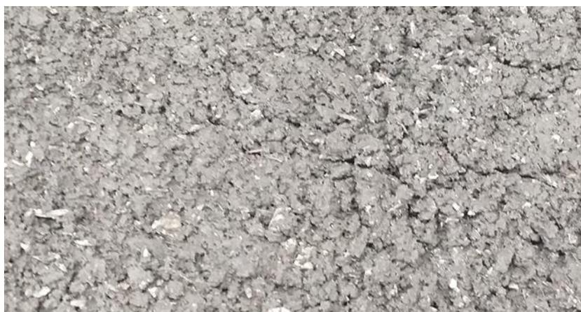
Figura 35: Figura da aparência da massa com 5% de plástico.
