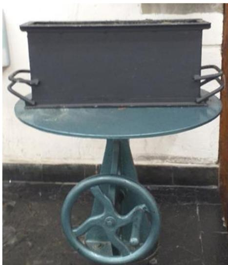
Figura 20: Figura do *flow table*.
