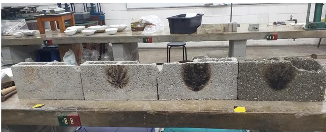
Figura 56: Figura da inflamabilidade dos blocos com aumento de plástico na composição.
