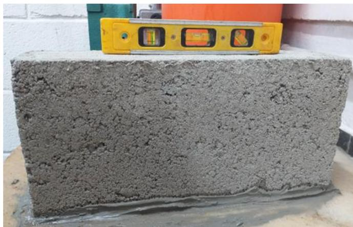
Figura 42: Figura do bloco recapeado e no nível.
