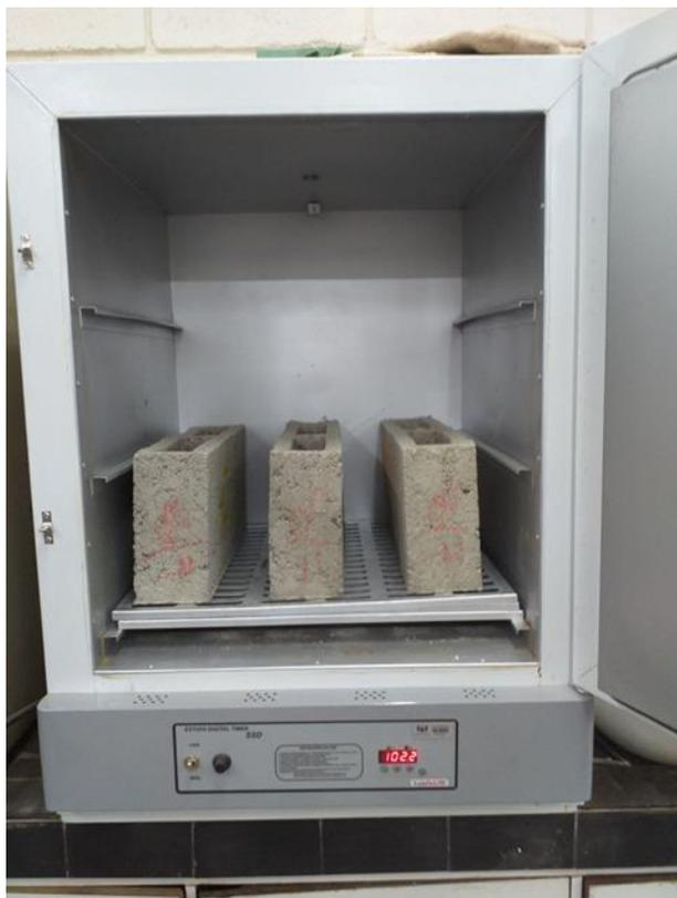
Figura 46: Figura dos modelos na estufa.
