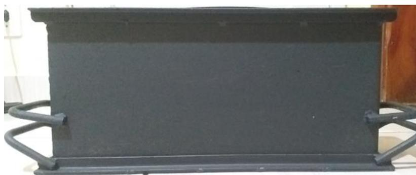
Figura 17: Figura da forma em aço carbono de 2 furos, vista em perfil.
