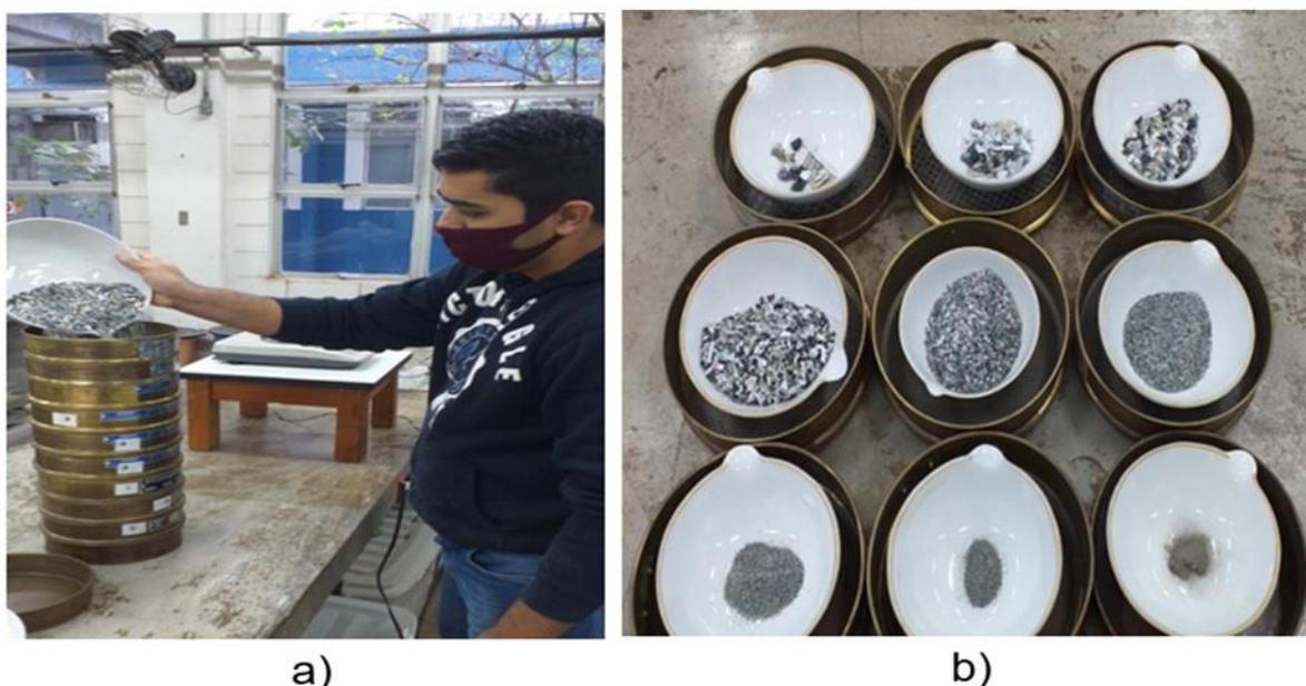
Figura 29 a): Execução do ensaio de granulometria; b) Material retido em cada peneira.
