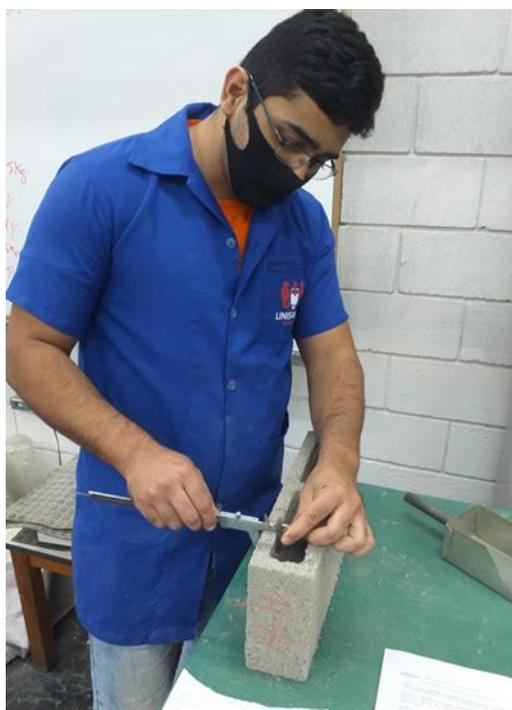
Figura 44: Figura da análise dimensional do bloco.
