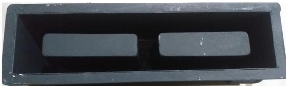
Figura 18: Figura da forma em aço inoxidável de 2 furos, vista superior.
