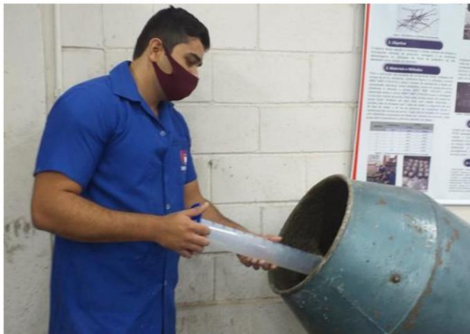
Figura 31: Figura da introdução da água na betoneira.
