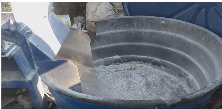
Figura 13: Figura do plástico tipo PP logo após sua saída da máquina.
