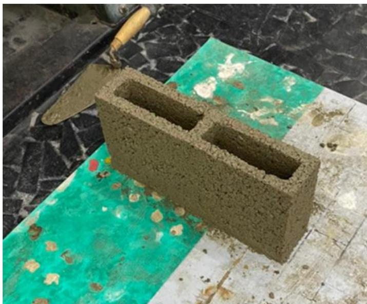
Figura 32: Figura do bloco de concreto sem adição de plástico.
