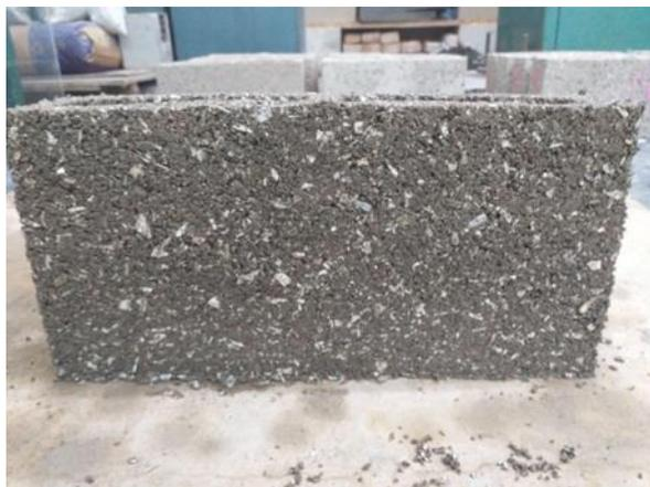
Figura 40: Figura do bloco produzido sem pedrisco.
