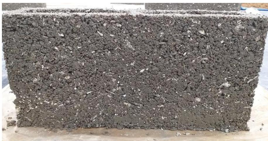
Figura 37: Figura do bloco com 10% de plástico.
