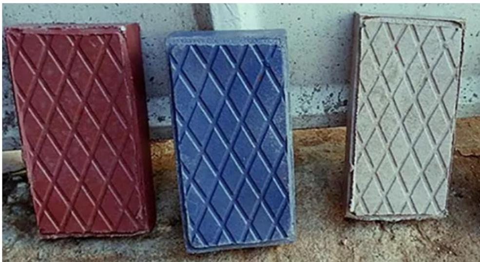
Figura 5: Figura de blocos feitos de plástico e areia.
