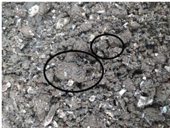
Figura 38: Figura da massa produzida com 15% de plástico.
