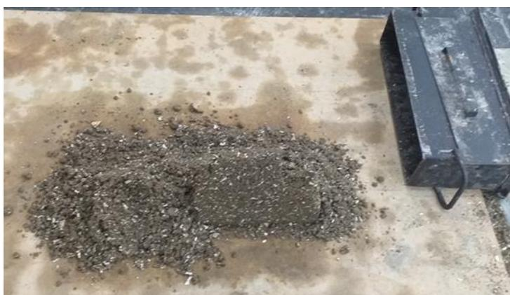
Figura 39: Figura da tentativa de produção do bloco com 15% de plástico.
