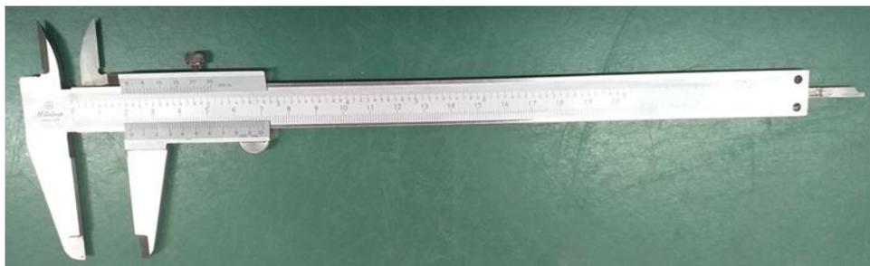
Figura 23: Figura do paquímetro graduado.
