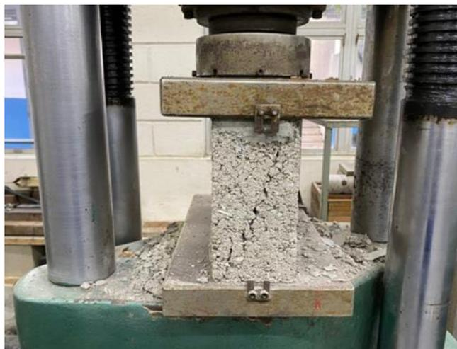
Figura 50: Corpo de prova na máquina de compressão.
