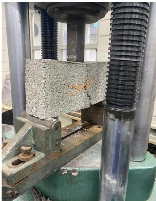
Figura 52: Figura do rompimento do bloco com 5% de plástico sob ação fletora.
