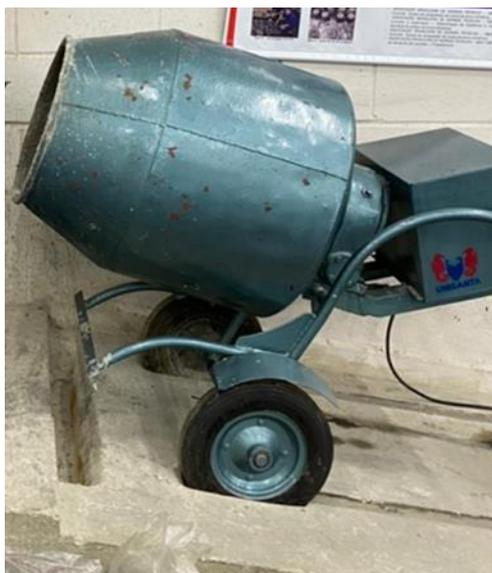
Figura 19: Figura da betoneira utilizada para homogeneização do concreto.
