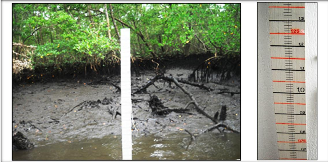
Figura 12. À esquerda, régua métrica fixada na margem do Rio Maratuá (estação oceanográfica 1). À direita, detalhes da régua utilizada em campo.
