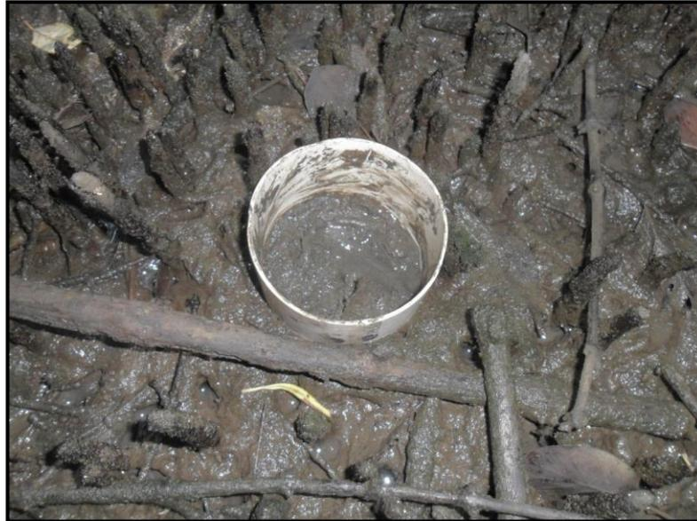
**Figura 8 – Limitador de PVC para coleta de estoque de serapilheira no solo**
