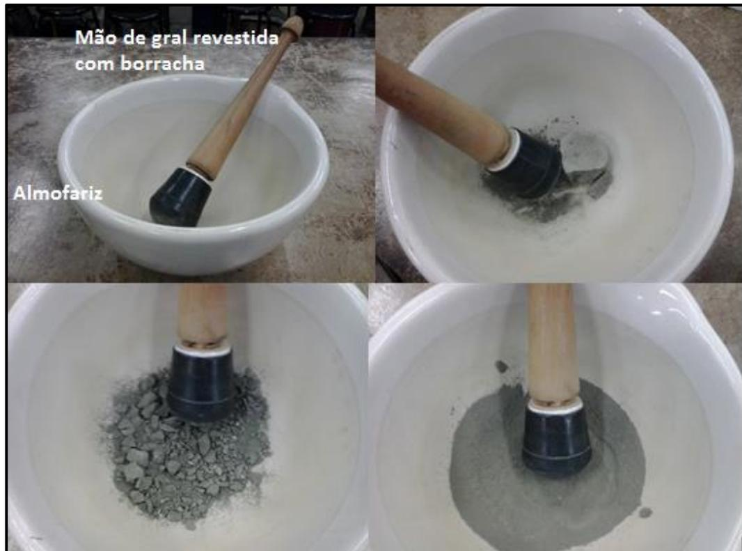
Figura 11 – Destorroamento do solo para análise granulométrica
