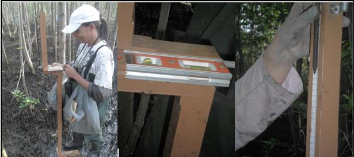
**Figura 12 - Instrumento para medir o grau de compactação do solo.**
