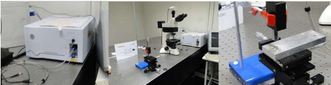
**Figura 19. Sistema Raman dispersivo utilizado para obtenção dos espectros das algas.**
