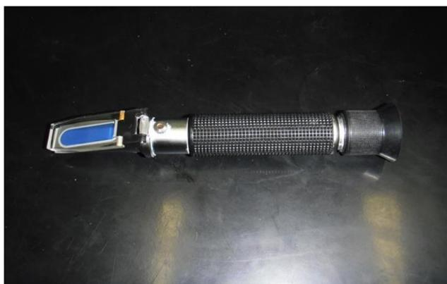
**Figura 6. Refratômetro utilizado para as medidas de salinidade.**
