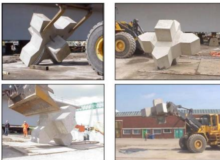
Figura 5 - Testes do protótipo Xbloc. Fonte: Hakenberg et al. 2004.
