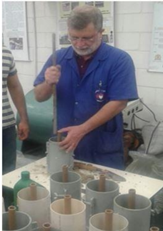
Figura 16 – Adensamento manual do concreto com haste.
