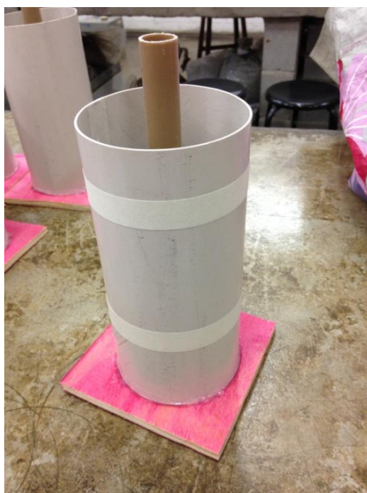
Figura 3 – Moldes dos CPs com fechamento provisório.
