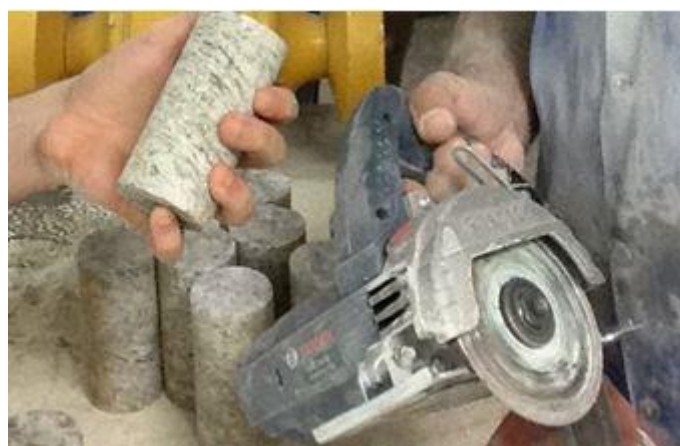
Figura 5 – Operação de corte do tarugo de rocha.
