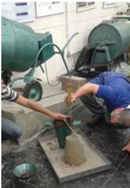
Figura 12 – Verificação do abatimento.
