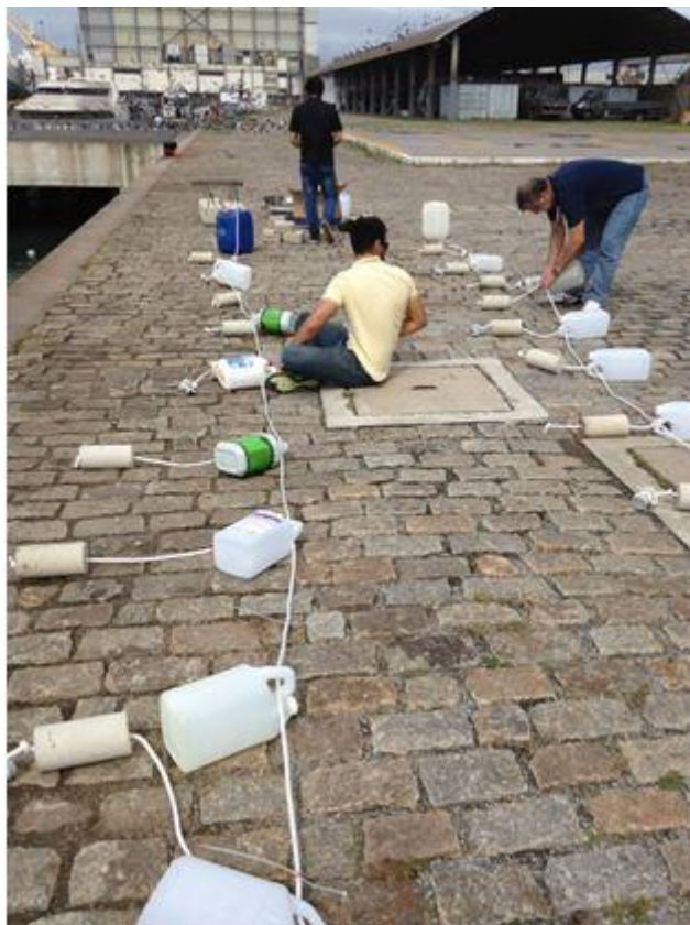
Figura 20 – Fixação dos CPs ao sistema de flutuação.
