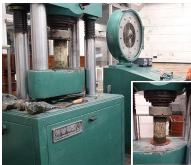
Figura 31 – Faces do corpo de prova em contato com a prensa – Detalhe.
