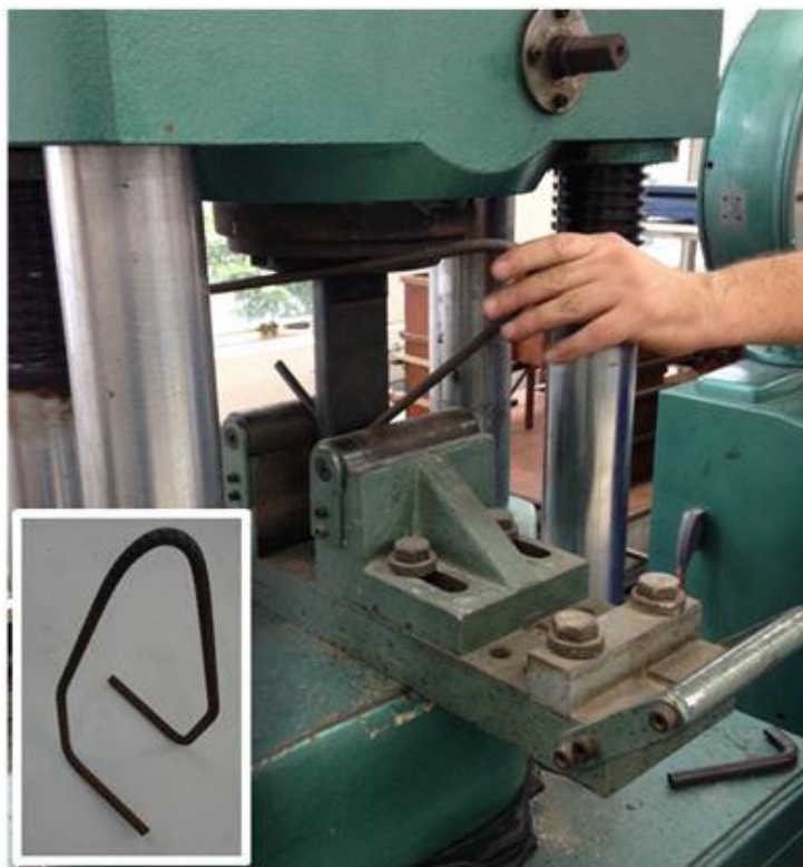
Figura 10 – Dobramento das barras e detalhe da peça - Detalhe.
