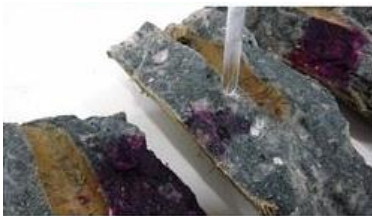
Figura 32 – Uso do indicador de pH (fenolftaleína) – Detalhe.
