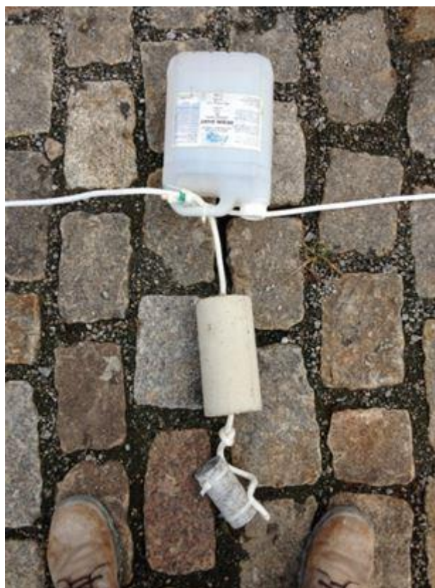
Figura 22 – CP fixado ao sistema de flutuação.
