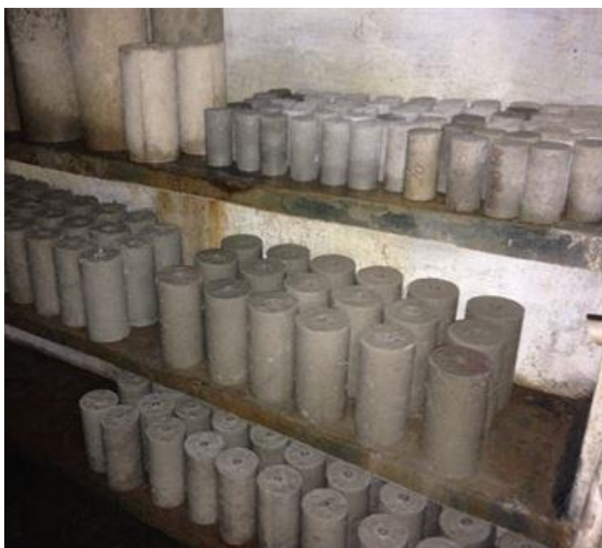
Figura 18 – Cura dos corpos de prova na câmara úmida.
