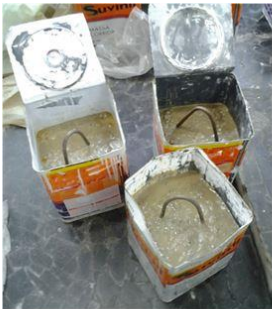
Figura 11 – Moldagem das poitas.
