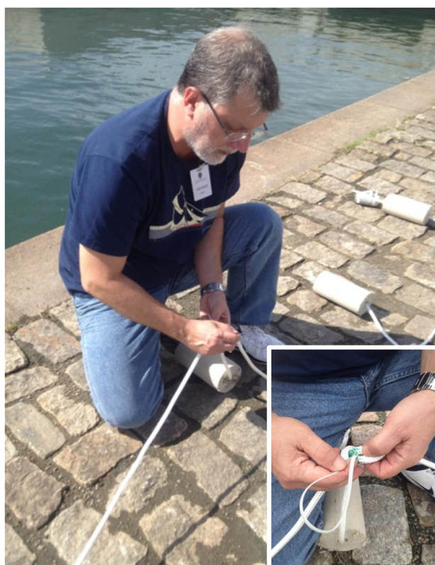
Figura 21 – fixação dos CPs ao sistema de flutuação – Detalhe.
