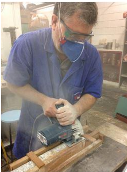
Figura 20 – Operação de corte do tarugo de rocha.
