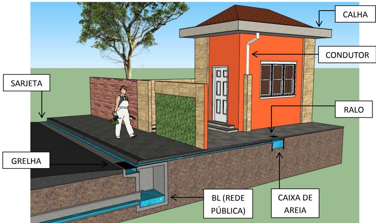
**Figura 4 – Perspectiva esquemática da drenagem de águas pluviais de uma residência (calha, condutor e caixa de areia) e com lançamento à rede pública.**
