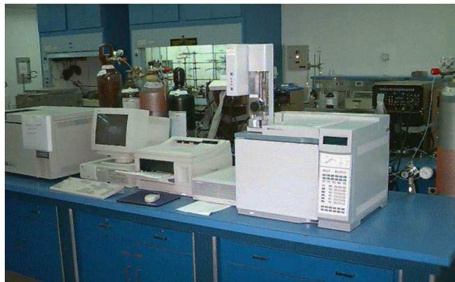
**Figura 01 – Cromatógrafo de laboratório.
