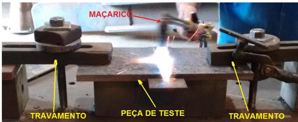
**Figura 28 – Manutenção da temperatura durante a soldagem.**
