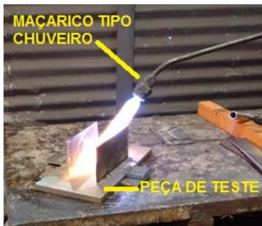
**Figura 22 – Peça submetida ao preaquecimento com maçarico.**
