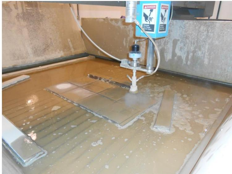
**Figura 18 - Máquina de corte com jato de água.**
