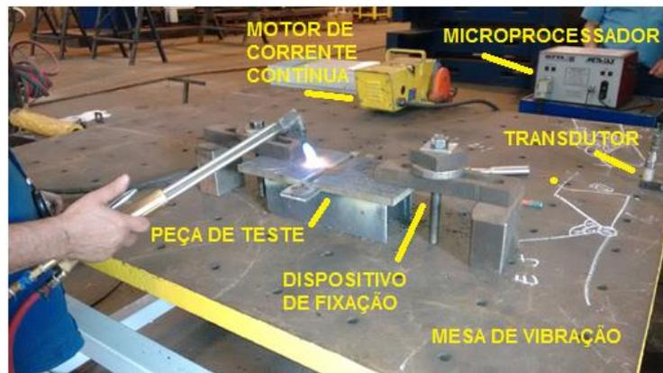
**Figura 26 – Mesa de vibração, transdutor de vibração, microprocessador, motor de corrente contínua, peça de teste e peça de fixação.**
