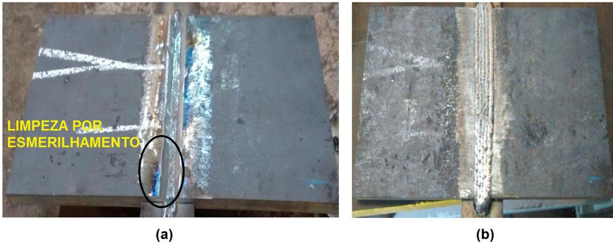
**Figura 30 – (a) Peça com detalhes da penetração e (b) Acabamento final da solda.**
