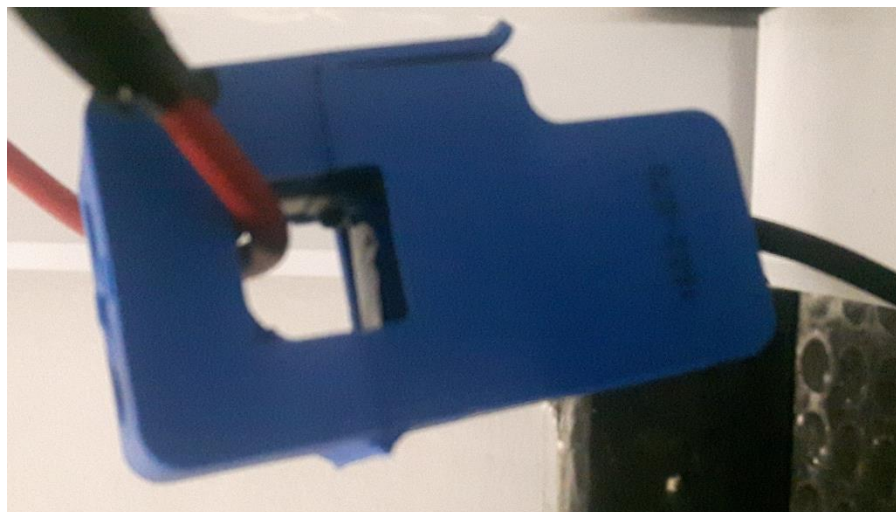
Figura 9 - O sensor de corrente SCT-013-000.
