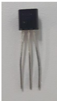
Figura 6 - O sensor LM35 com encapsulamento TO-92.
