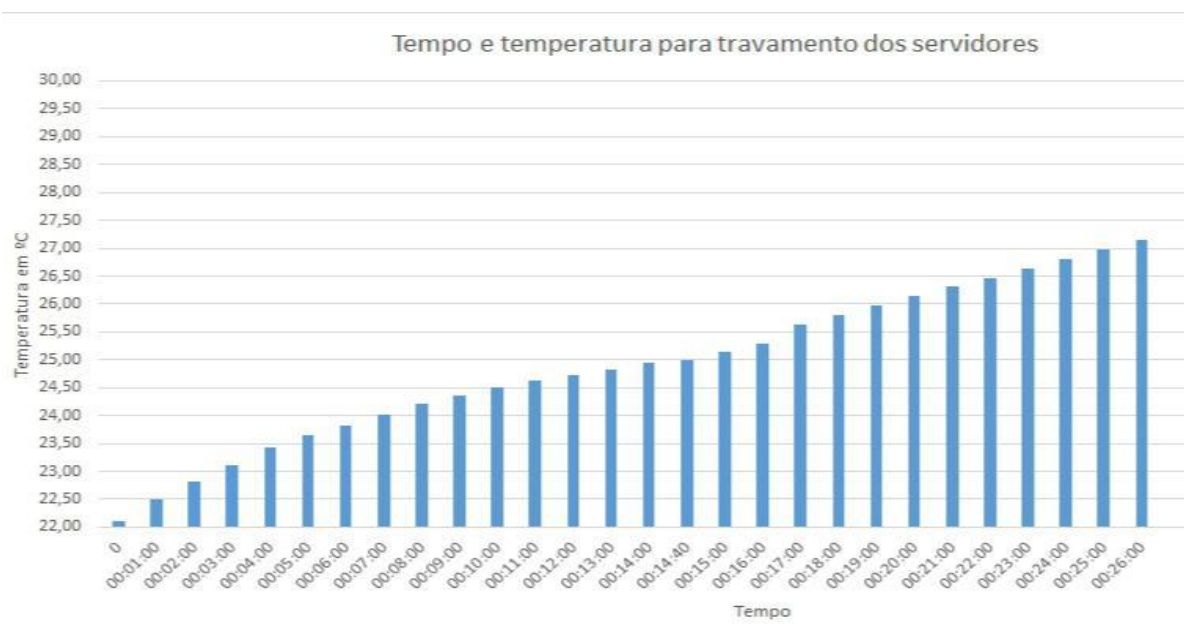
Figura 37 - Tempo e temperatura para o travamento dos servidores do data center .
