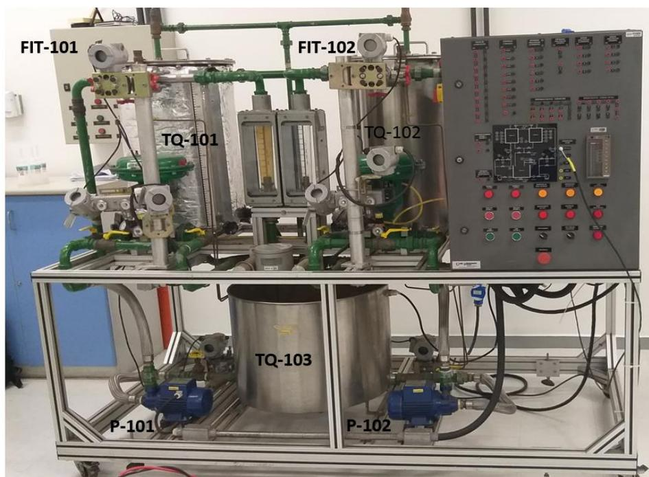
Figura 9 – Visão geral da planta piloto de processo industrial usada nos testes de validação da estação de razão paraconsistente.
