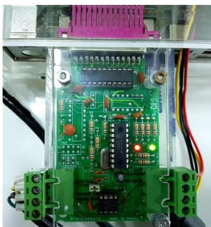
Figura 21 – Placa de interface de comunicação para rede CAN.
