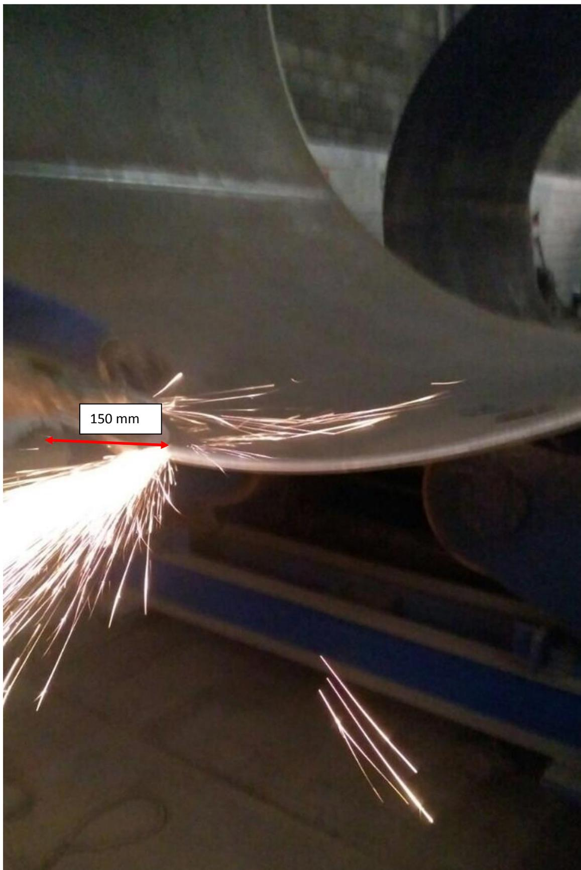
Figura 47: Posição do operador em proximidade da esmerilhadeira.
