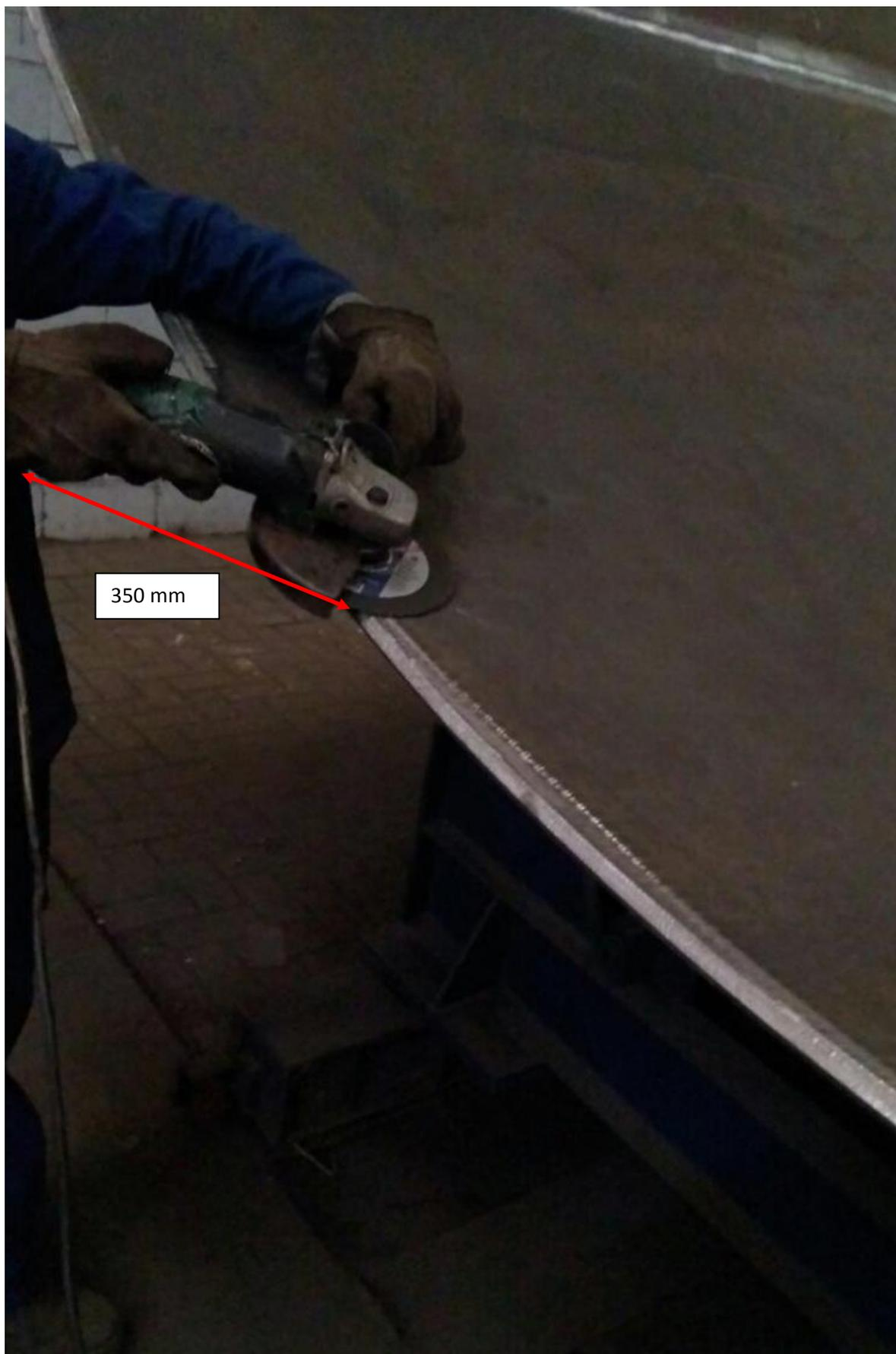
Figura 46: Posição do operador em proximidade da esmerilhadeira.
