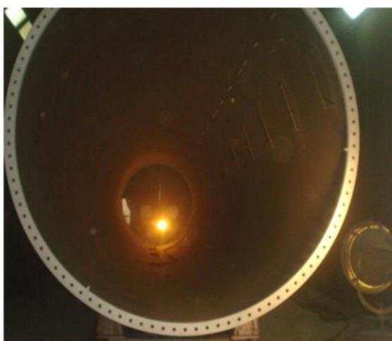
**Figura 10: Montagem e acabamento dos componentes internos de uma torre eólica.**
