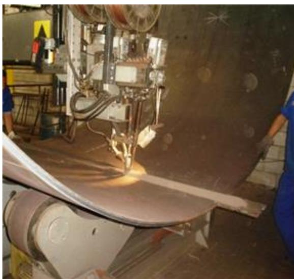
**Figura 6: Soldagem Longitudinal de uma seção tronco-cônica de uma torre eólica pelo processo de arco submerso.**
