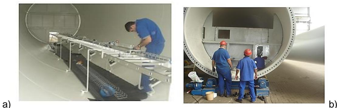
**Figura 14: Preparação dos componentes internos de uma torre eólica a) montagem da escadaria e plataforma de segurança e b) montagem de instalações elétricas.**
