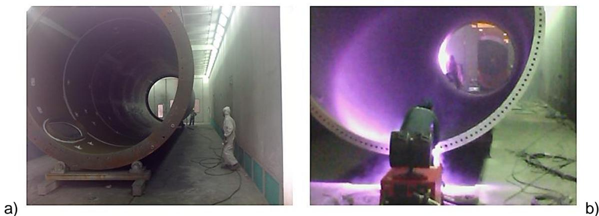
**Figura 13: Acabamento interno e externo de uma torre eólica a) jateamento e b) metalização e pintura.**
