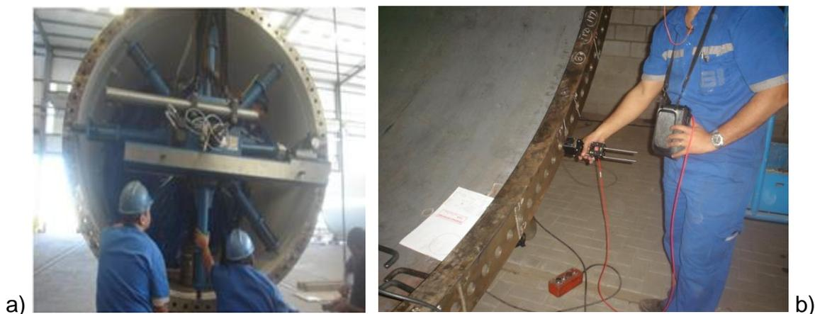
**Figura 9: Flangeamento de uma seção tronco-cônica de uma torre eólica a) alinhamento e b) paralelismo.**
