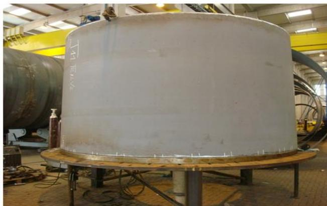
**Figura 7: Aspecto de uma seção tronco-cônica de uma torre eólica sendo preparada para receber a soldagem de seu flange.**
