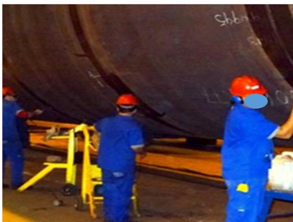
**Figura 11: Ensaios por Ultrassom das seções de uma torre eólica.**
