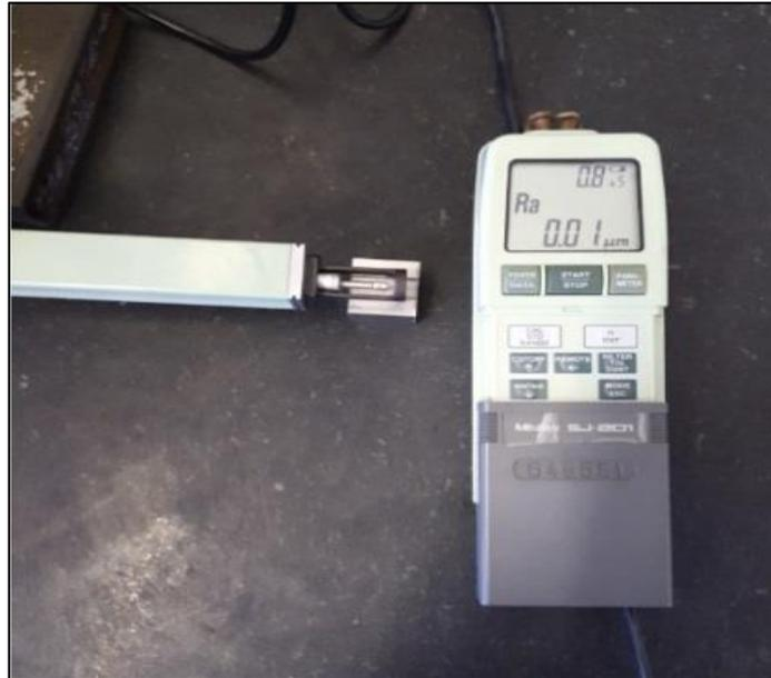
Figura 25 – Rugosímetro Mitutoyo modelo SJ-201.
