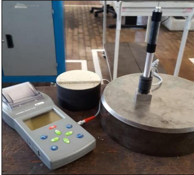
**Figura 26 – Durômetro portátil TIME GROUP INC TH 160.**
