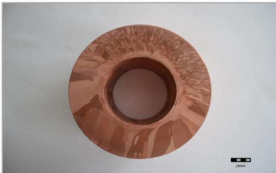
**Figura 33 - Macrografia da secção transversal na velocidade de 180,0 mm/min.**
