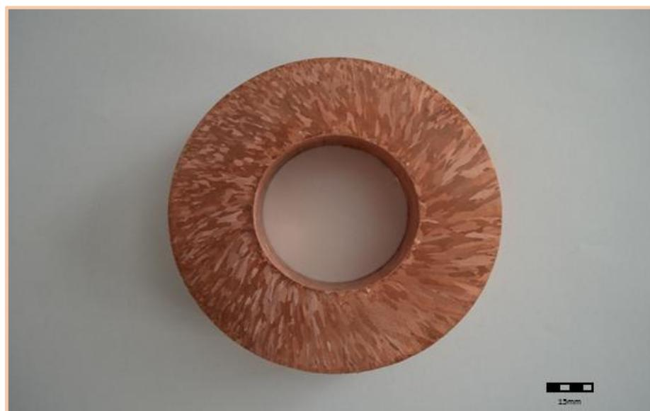
**Figura 35 - Macrografia da secção transversal na velocidade de 258,7 mm/min.**
