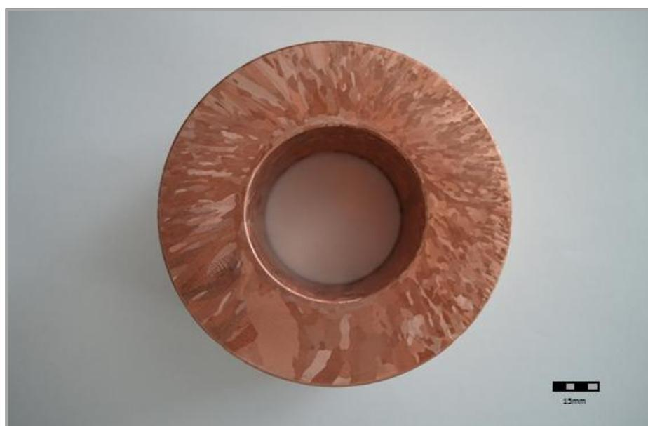
**Figura 34 - Macrografia da secção transversal na velocidade de 224,5 mm/min.**
