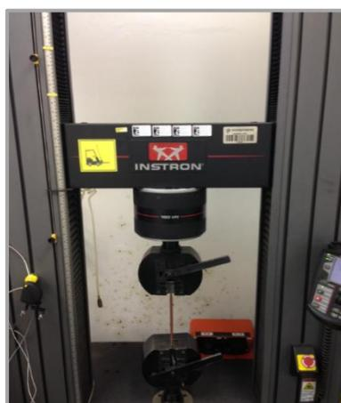
**Figura 30 - Equipamento para ensaio de tração.**
