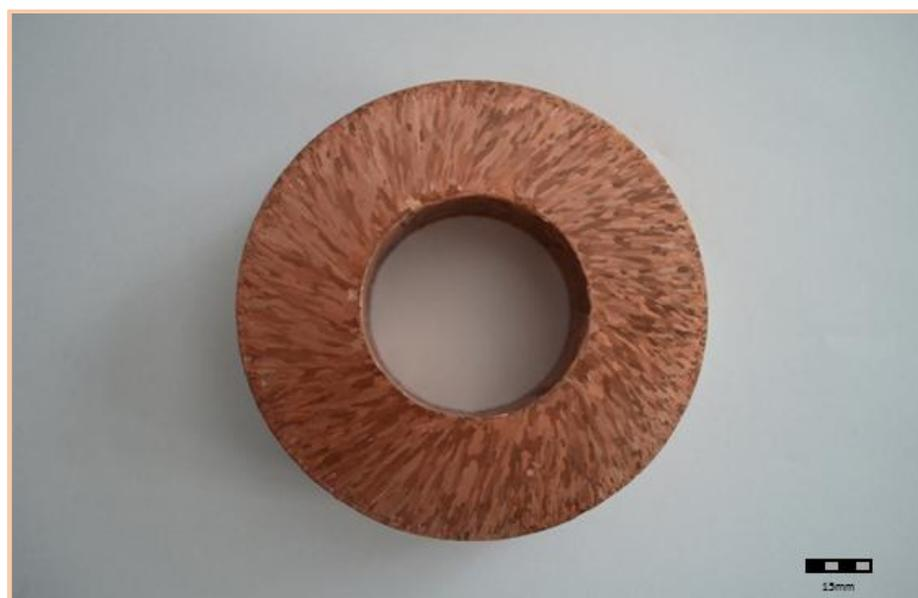
**Figura 36 - Macrografia da secção transversal na velocidade de 302,4 mm/min.**
