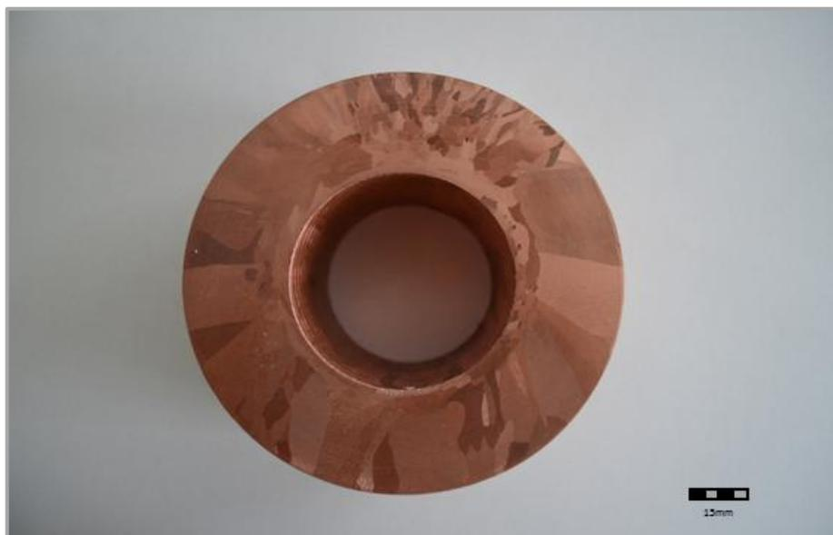
**Figura 32 - Macrografia da seção transversal na velocidade de 123,1 mm/min.**
