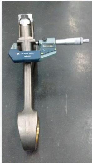
**Figura 23 – Micrômetro externo na medição da biela.**
