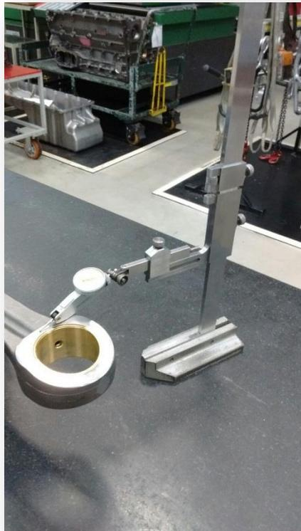
**Figura 25 – Relógio apalpador com traçador de altura na medição da biela.**
