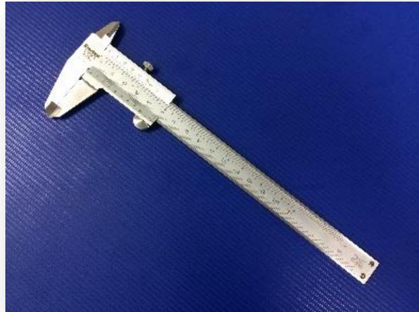
Figura 14 – Paquímetro universal.
