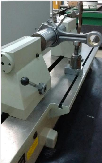
Figura 21 – Dispositivo entre-pontas na medição da biela.
