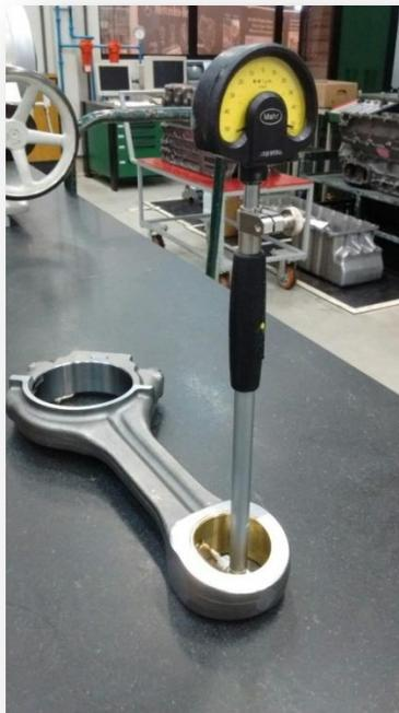
**Figura 22 – Súbito na medição da biela.**
