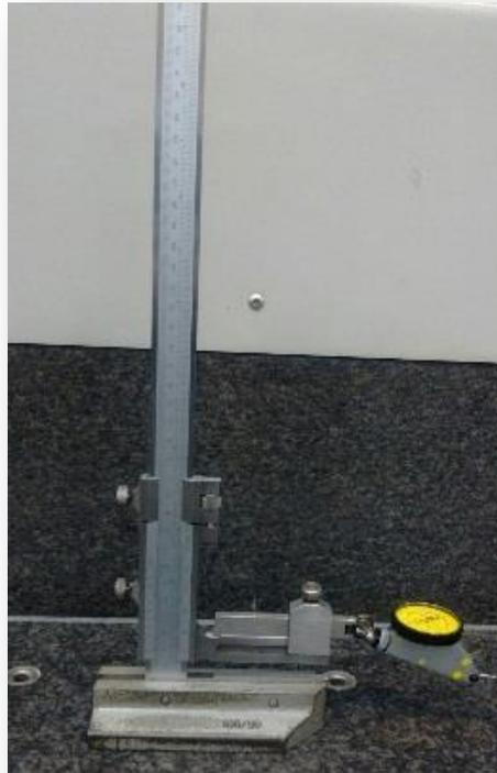
Figura 19 – Relógio apalpador com traçador de altura.
