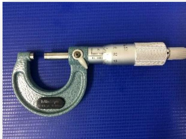
Figura 15 – Micrômetro externo.
