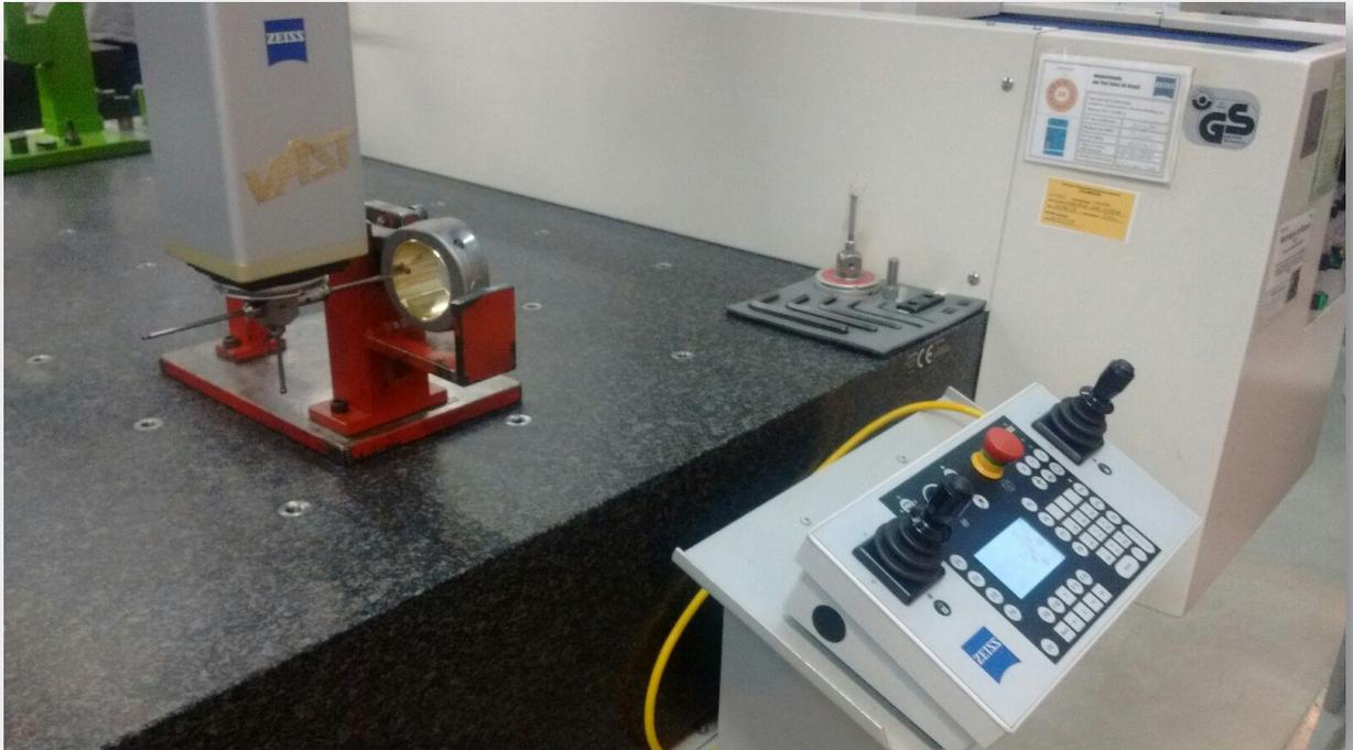
**Figura 26 – MMC tridimensional na medição da biela.**
