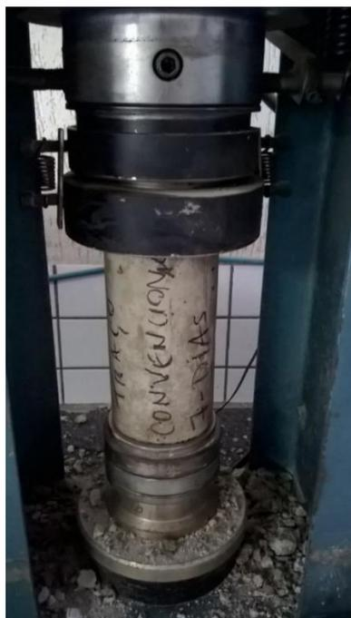
**Figura 36: Rompimento do Corpo de prova 7 dias.**
