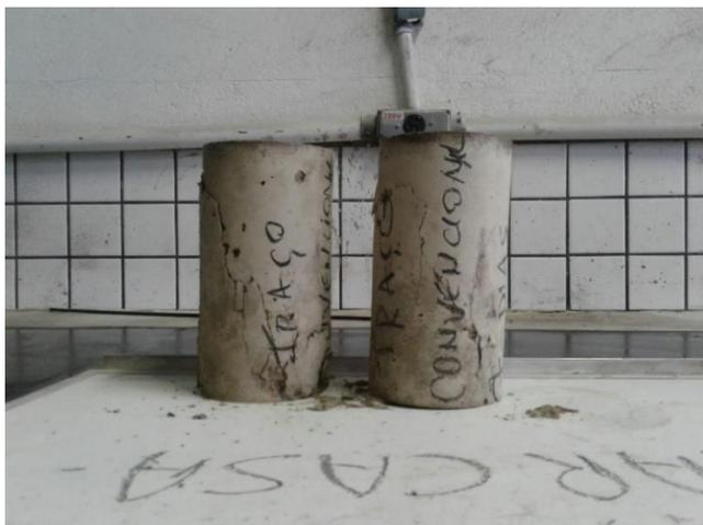
Figura 37: Corpo de prova rompido 7 dias – traço 1.
