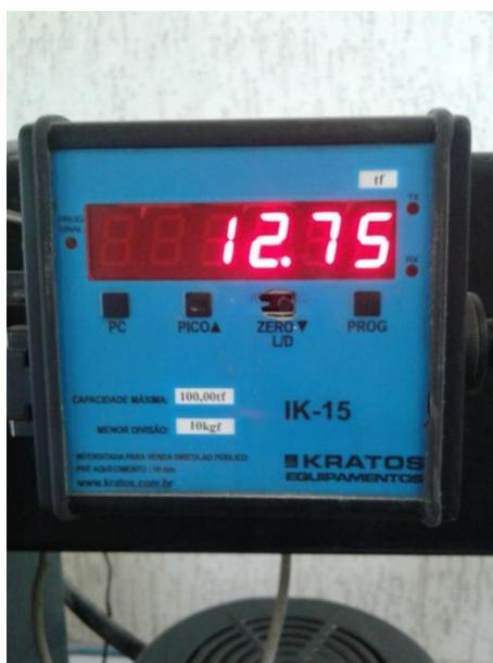
Figura 66: Carga no momento da ruptura do Corpo de prova 7 - traço 2.
