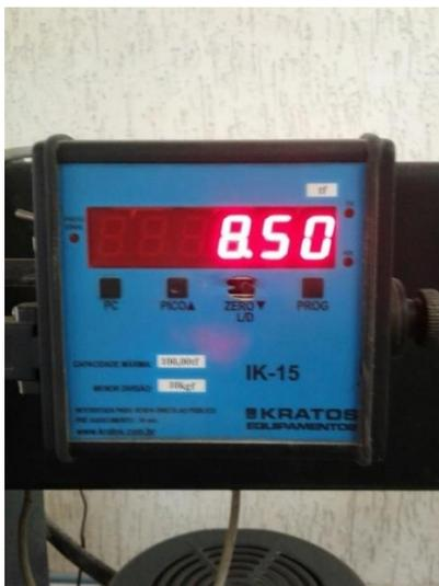
**Figura 77: Carga no momento da ruptura do Corpo de prova 16 - traço 4.**
