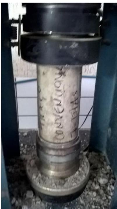
Figura 38: Rompimento do Corpo de prova 7 dias – traço 2.
