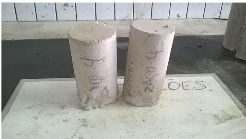
**Figura 49: Corpo de prova rompido 7 dias – traço 4.**
