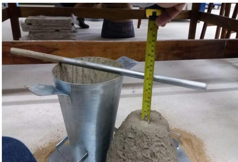
**Figura 25: *Slump Test* traço 1.**
