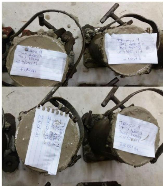
Figura 50 Corpo de Prova 7 dias - traço 4.
