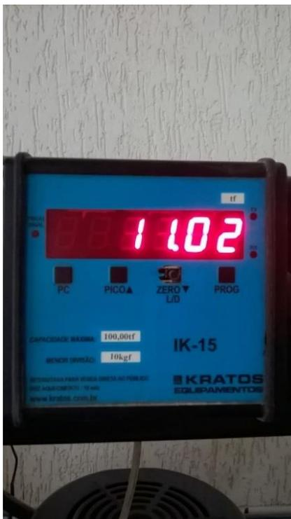
Figura 61: Carga no momento da ruptura do Corpo de prova 1 - traço 1.
