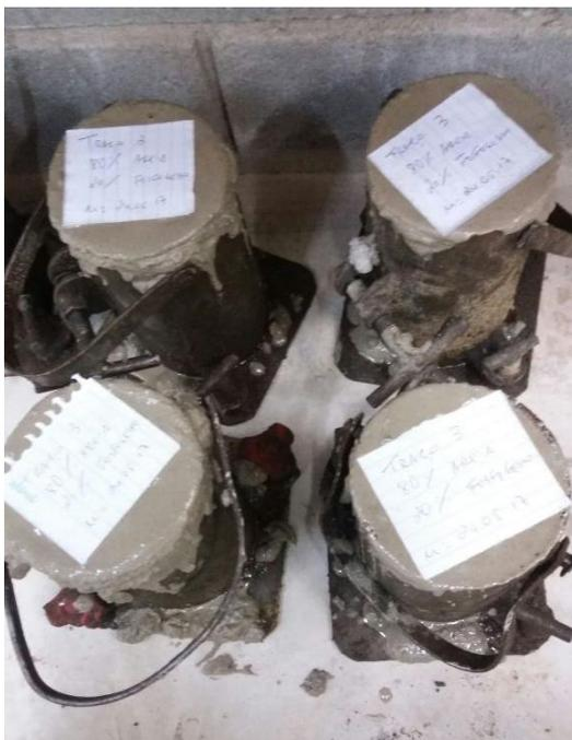
Figura 44: Corpo de Prova 7 dias - Traço 3.
