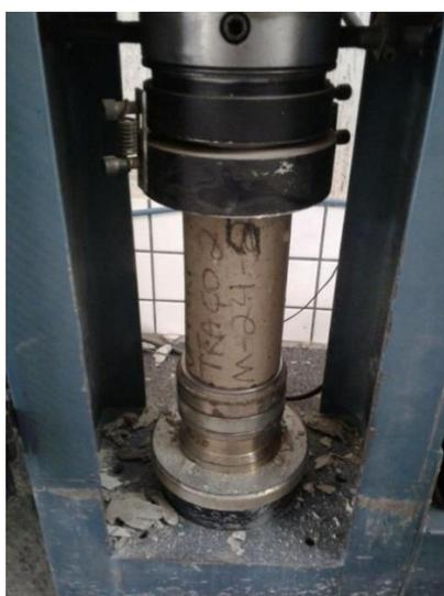
**Figura 41: Rompimento do Corpo de prova 28 dias – traço 2.**
