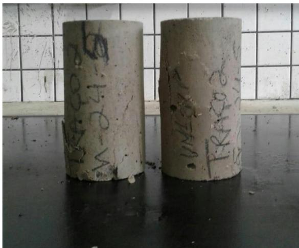
**Figura 42: Corpo de prova rompido 28 dias – traço 2.**
