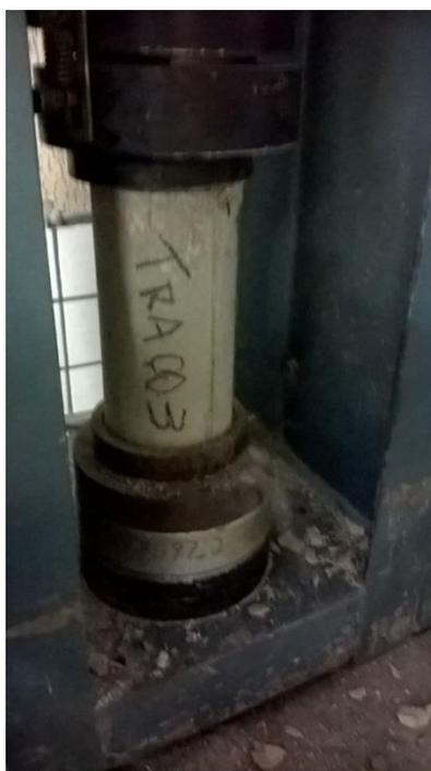
**Figura 43: Rompimento do Corpo de prova 7 dias – traço 3.**
