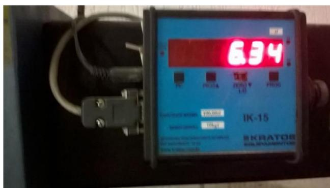
Figura 70: Carga no momento da ruptura do Corpo de prova 10 - traço 3.
