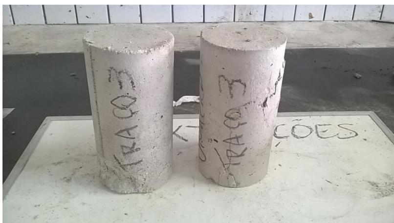
Figura 45: Corpo de prova rompido 7 dias – traço 3.
