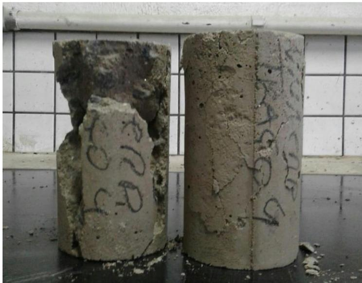
Figura 52: Corpo de prova rompido 28 dias – traço 4.
