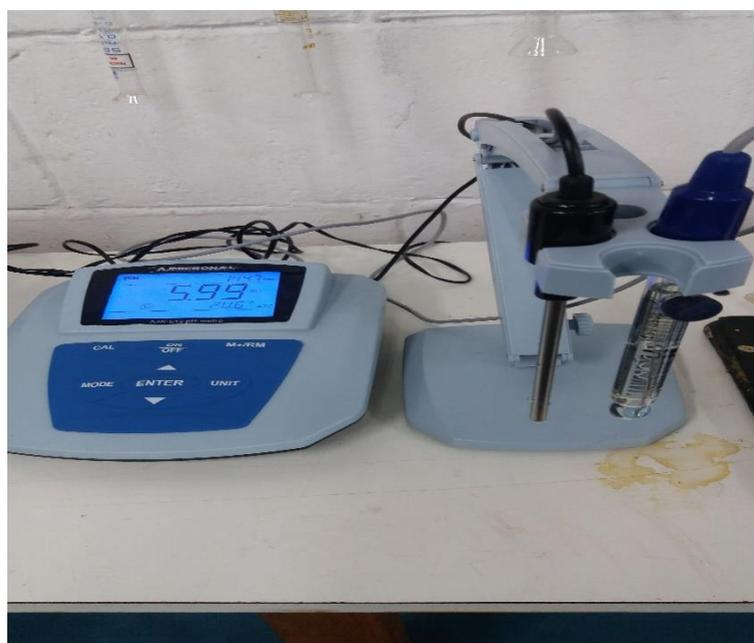
Figura 54: Medidor digital de pH.
