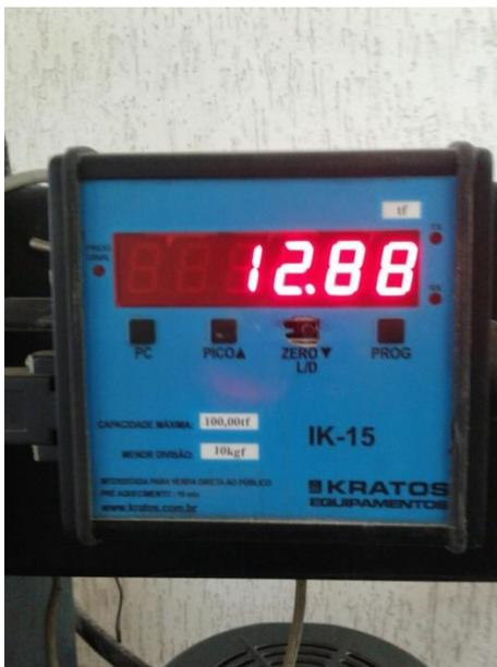
Figura 67: Carga no momento da ruptura do Corpo de prova 8 - traço 2.
