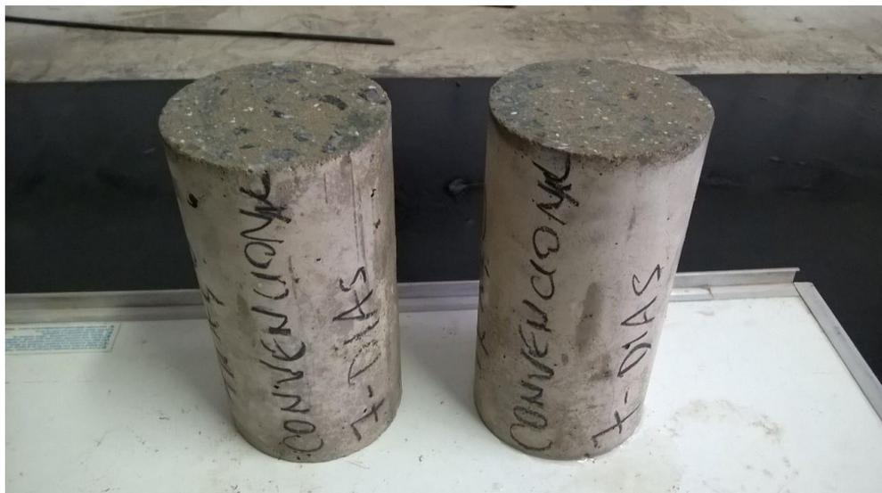
**Figura 35: Corpo de prova 7 dias – traço 1.**
