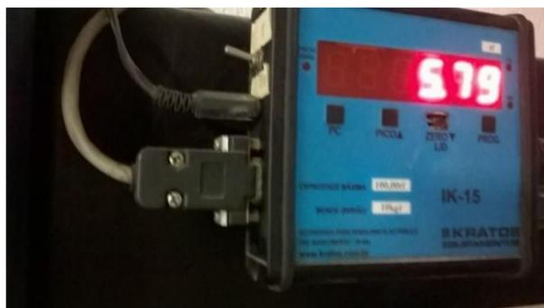
Figura 75: Carga no momento da ruptura do Corpo de prova 14 - traço 4.
