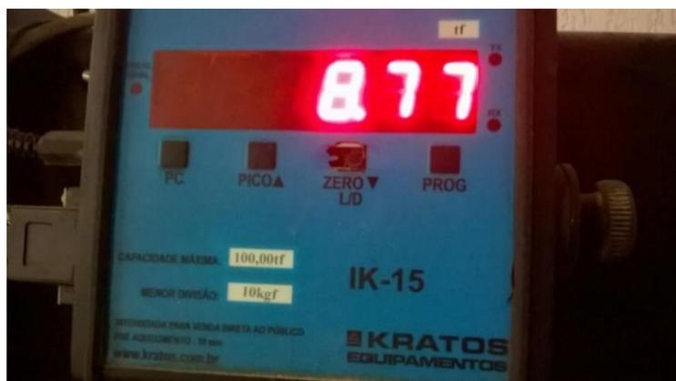
**Figura 64: Carga no momento da ruptura do Corpo de prova - 5 traço 2.**
