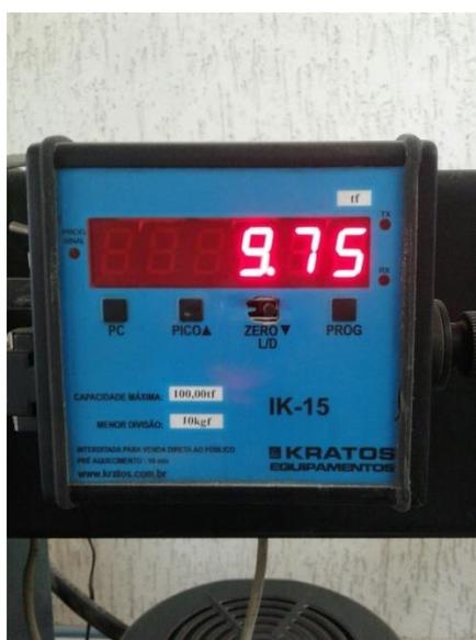
Figura 71: Carga no momento da ruptura do Corpo de prova 11 - traço 3.
