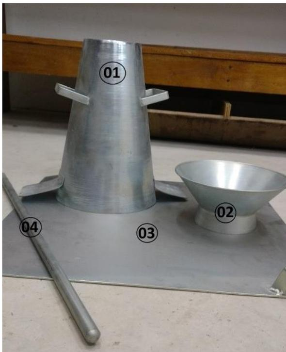
Figura 18: Equipamentos do *Slump Test*.
