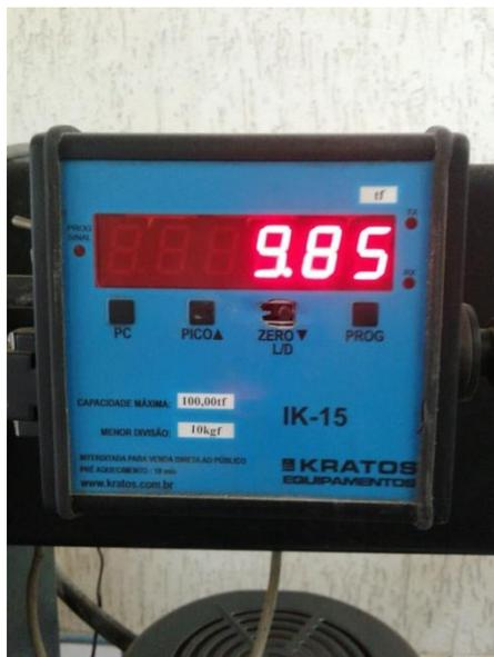
Figura 72: Carga no momento da ruptura do Corpo de prova 12 - traço 3.
