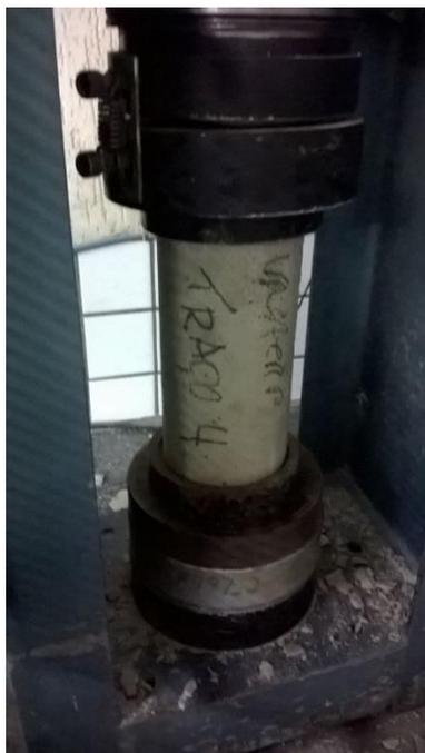
**Figura 48: Rompimento do Corpo de prova 7 dias – traço 4.**
