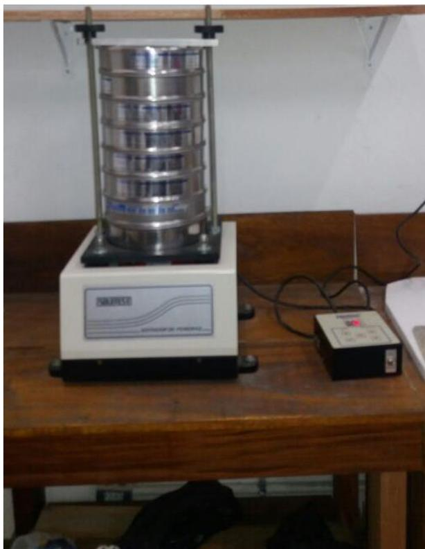
**Figura 11: Agitador Mecânico.**
