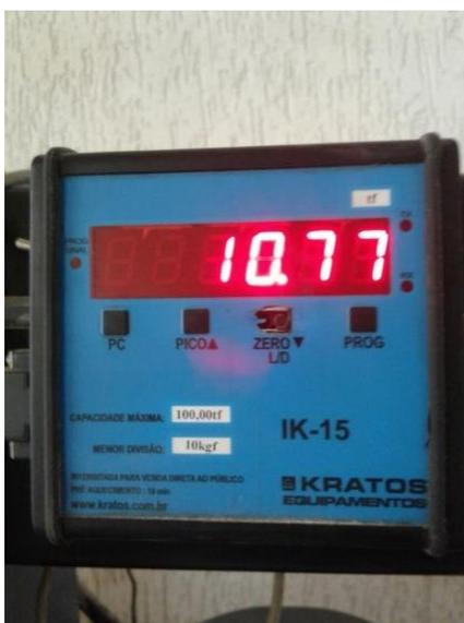
Figura 62: Carga no momento da ruptura do Corpo de prova 2 - traço 1.
