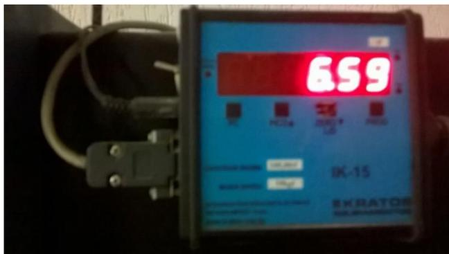
Figura 69: Carga no momento da ruptura do Corpo de prova 9 - traço 3.
