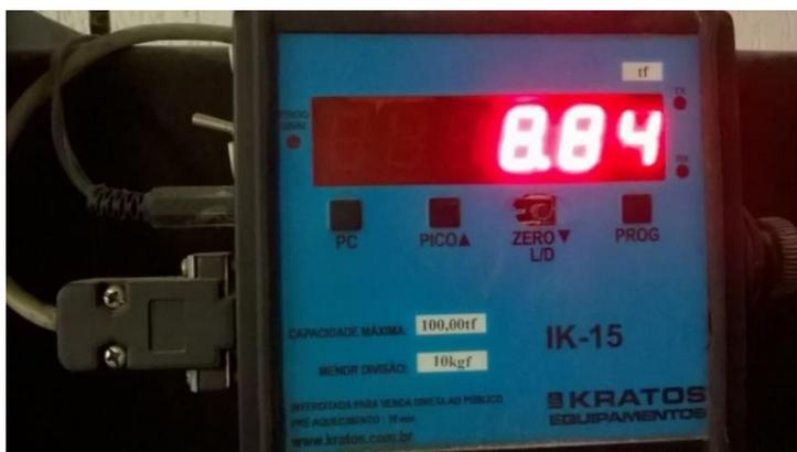
Figura 65: Carga no momento da ruptura do Corpo de prova 6 - traço 2.
