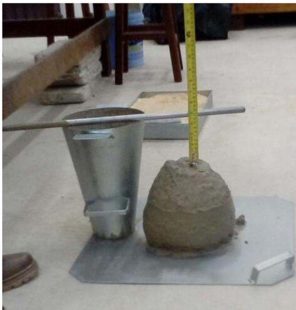
Figura 28: *Slump Test* traço 2.
