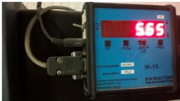
Figura 74: Carga no momento da ruptura do Corpo de prova 13 - traço 4.
