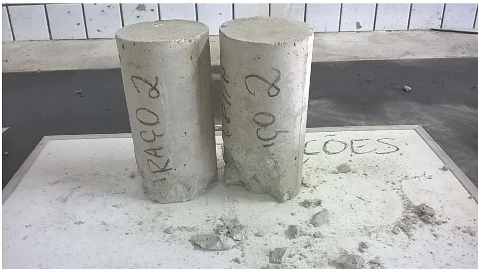
**Figura 39: Corpo de prova rompido 7 dias – traço 2.**
