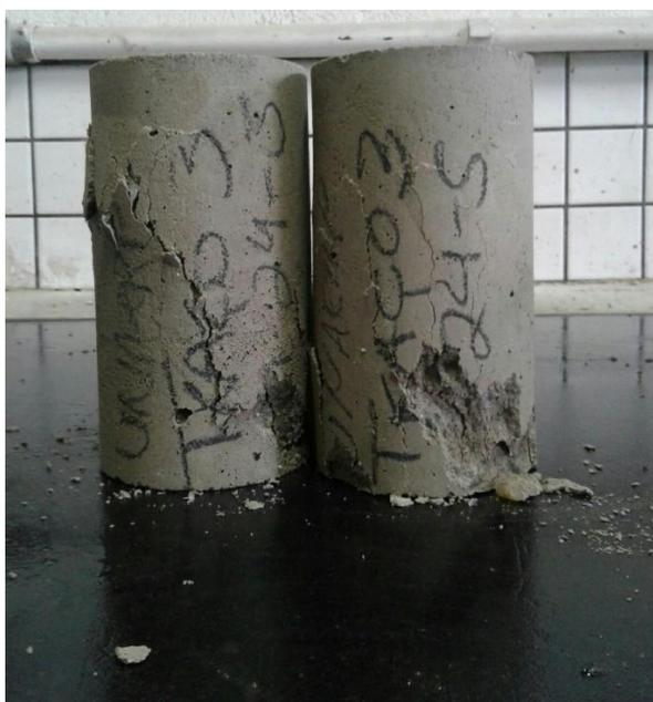
**Figura 47: Corpo de prova rompido 28 dias – traço 3.**
