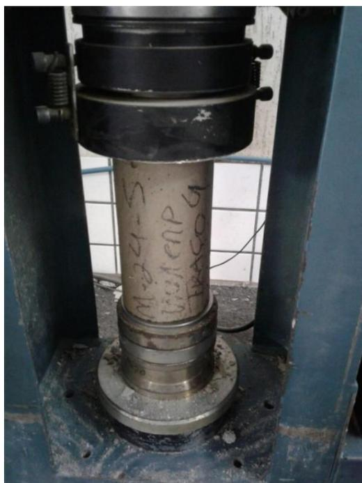
Figura 51: Rompimento do Corpo de prova 28 dias – traço 4.
