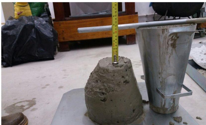
Figura 31: *Slump Test* traço 3.
