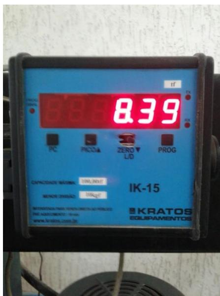
Figura 76: Carga no momento da ruptura do Corpo de prova 15 - traço 4.
