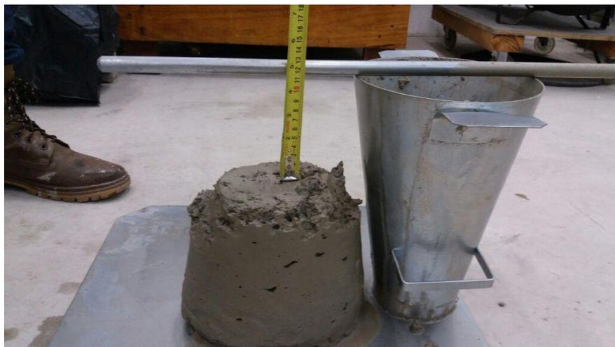
Figura 34: *Slump Test* traço 4.
