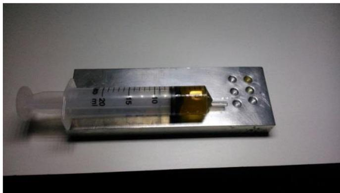
**Figura 12. Porta amostras com furos  $\varnothing$  de 6mm e 3mm de profundidade.**
