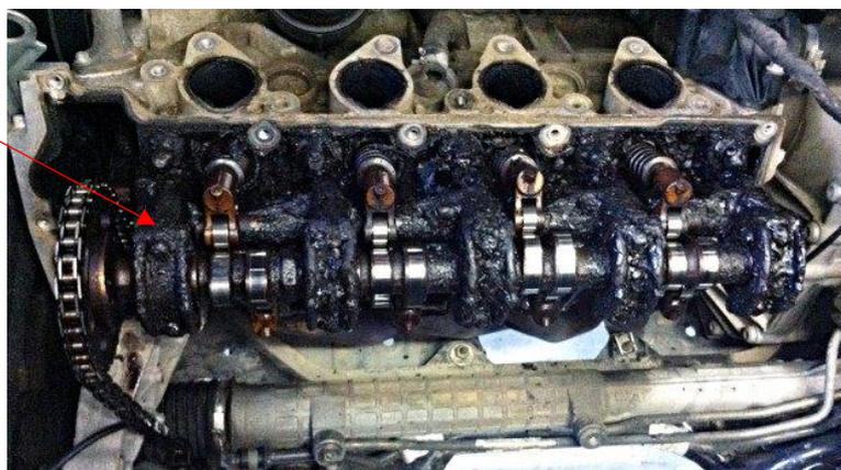
**Figura 3. Motor automotivo com óleo lubrificante inadequado.**
