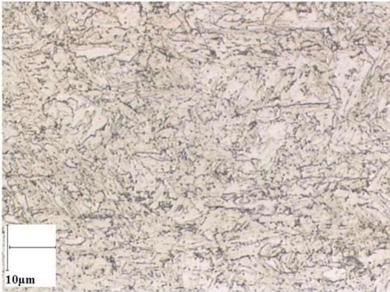
**Figura 14: Microestrutura de um aço CP.**
