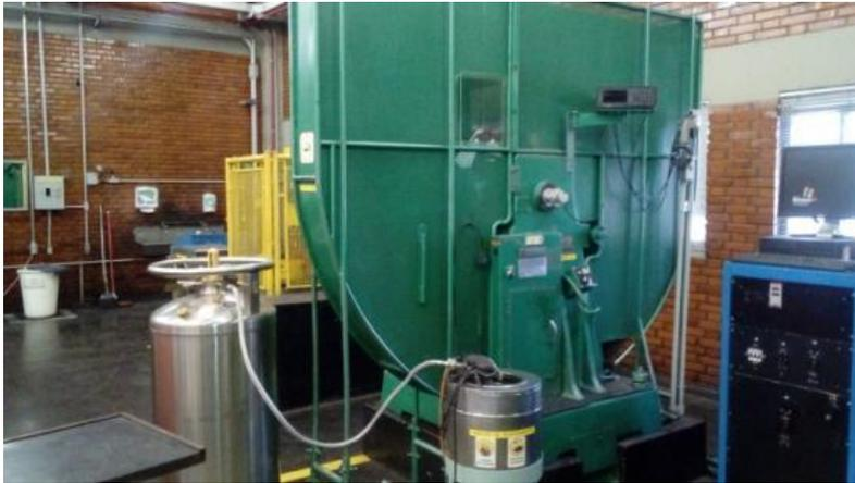
**Figura 95: Máquina de ensaio de impacto Charpy com capacidade de 30 Kgm, fabricante SHIMADZU.**
