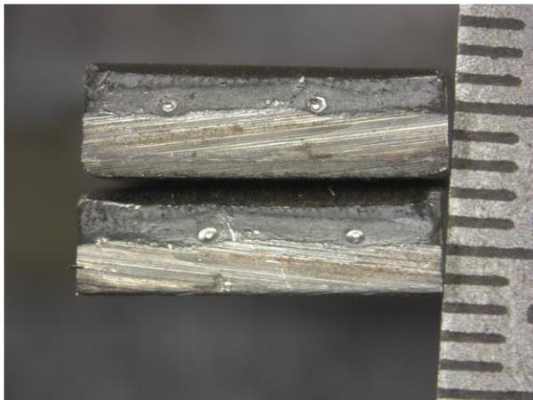
**Figura 98: Aspecto macrográfico da fratura do corpo de prova de uma junta soldada com ER110S-G submetido ao ensaio de tração, que rompeu devido falta de penetração da solda.**
