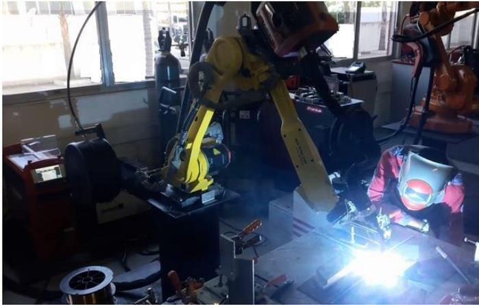
**Figura 63: Soldagem GMAW (TPS/i Fronius acoplada no robô).**
