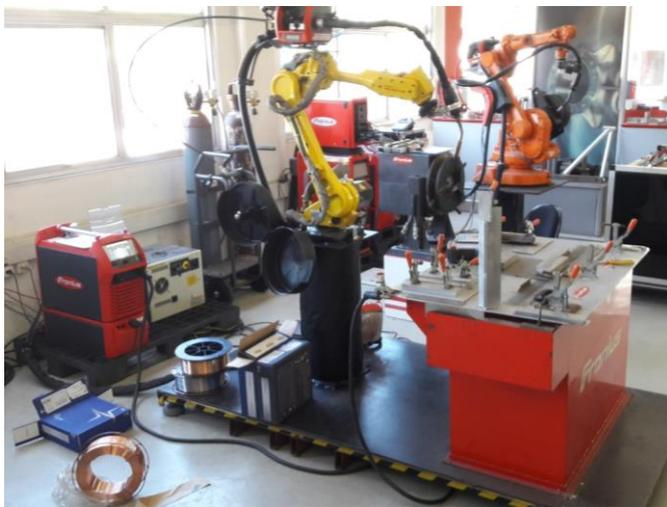
**Figura 47:** Equipamento de soldagem GMAW utilizada (TPS/i Fronius acoplada no robô).
