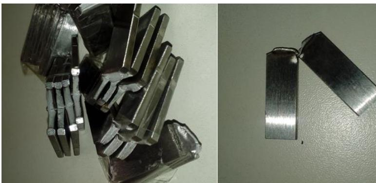
**Figura 96: Corpos de prova após a ruptura no ensaio de impacto Charpy.**
