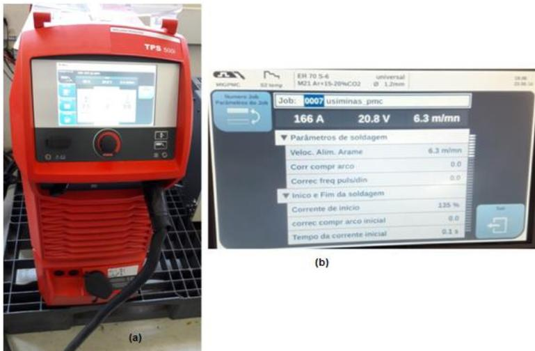
**Figura 64: Parâmetros iniciais programados para soldagem.(a) equipamento de soldagem TPS/i. (b) tela com os parâmetros programados para execução da soldagem**
