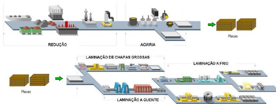
**Figura 15: Fluxo de Produção de uma siderurgia integrada.**
