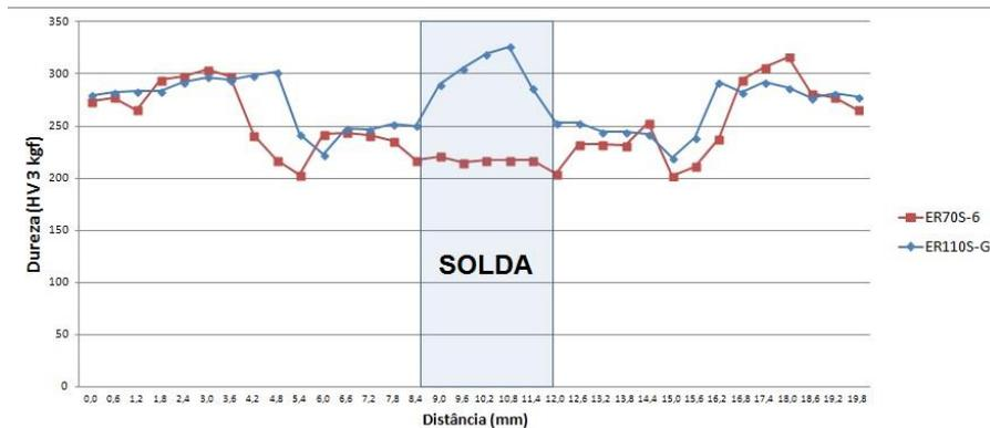
**Figura 108: Comparativo das durezas obtidas nas juntas soldadas com o consumível ER70S-6 e ER110S-G.**
