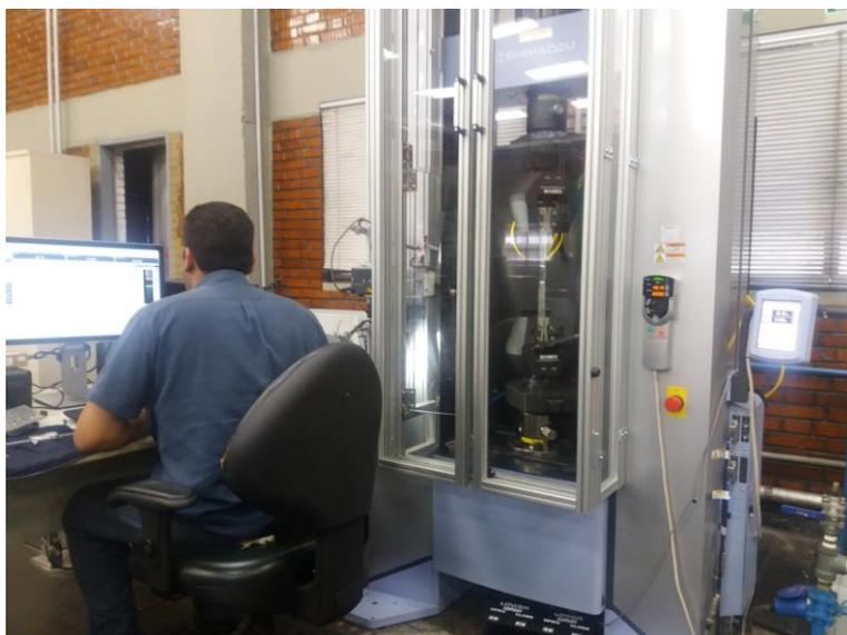
Figura 56: Máquina de tração de 300kN utilizada na realização dos ensaios dos corpos de prova de *complex phase*.
