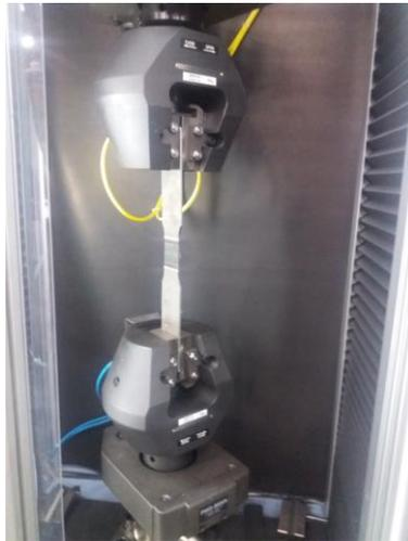
Figura 70: Ensaio de tração de um aço *complex phase grau 800* soldado através do processo GMAW utilizando consumível ER70S-6.
