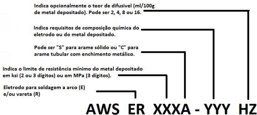
Figura 33: Formato da especificação para arames sólidos e arames com enchimento metálico, conforme AWS.
