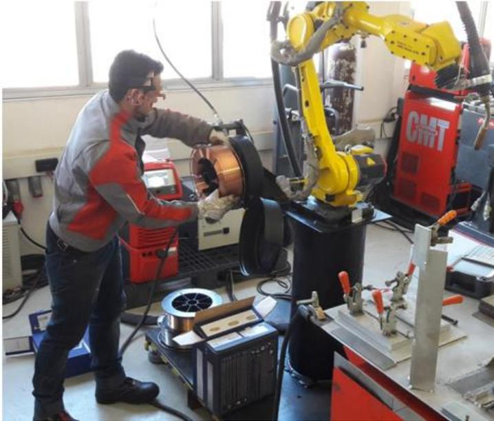
Figura 48: Colocação do arame Böhler para a realização da soldagem robotizada.
