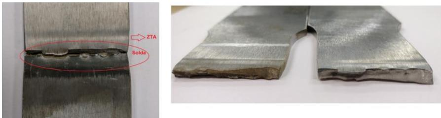
**Figura 79: Ruptura do corpo de prova na região da junta soldada.**
