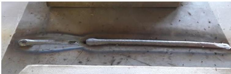
**Figura 65: Rompimento do cordão de solda durante o processo de soldagem.**
