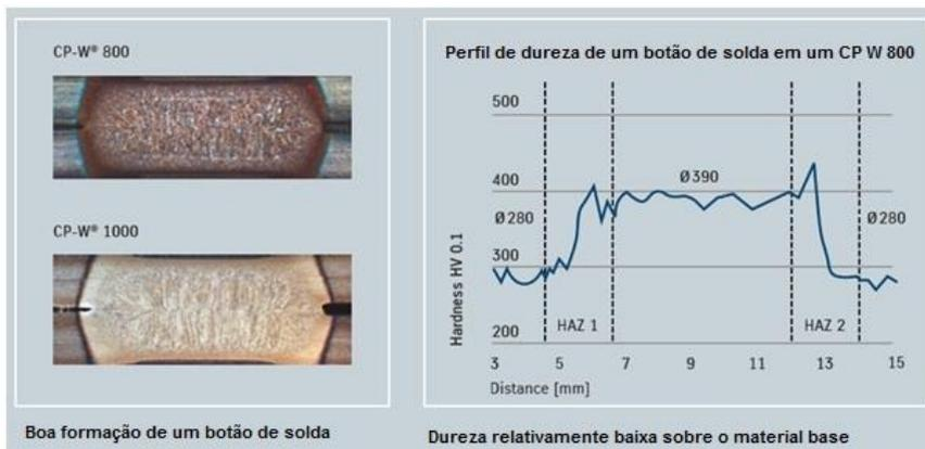
Figura 38: Propriedades do botão de solda de um aço *complex phase* laminado a quente.
