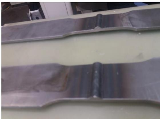
**Figura 68: Corpo de prova preparado para ensaio de tração conforme norma AWS B4.0M (2000), de aço *complex phase* 800 soldado com ER70S-6, sem a retirada do reforço de solda.**
