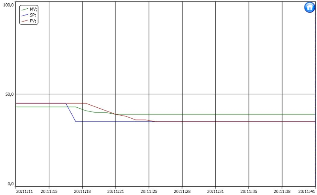
Figura 19. Resposta do Bloco NAP\_PARACON para um SP 35%.
