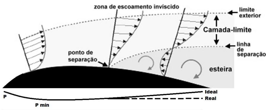
**Figura 23 – Linhas de corrente e forma de escoamento próximo ao ponto de separação da camada limite e perfil de pressão.**
