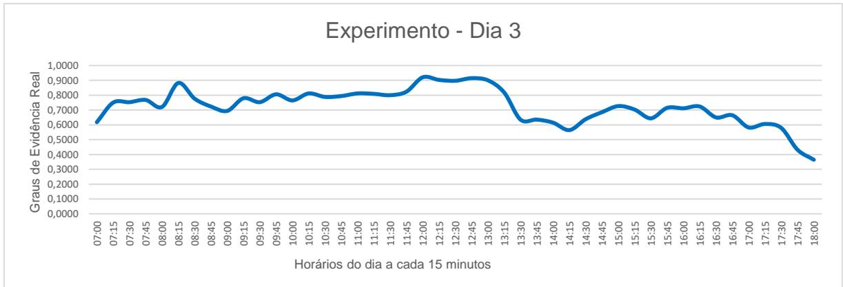
**Figura 17 – Resultado do NAP durante o terceiro dia de experimento com medidas de hora em hora relacionado a proposição “O painel está plenamente iluminado”.**
