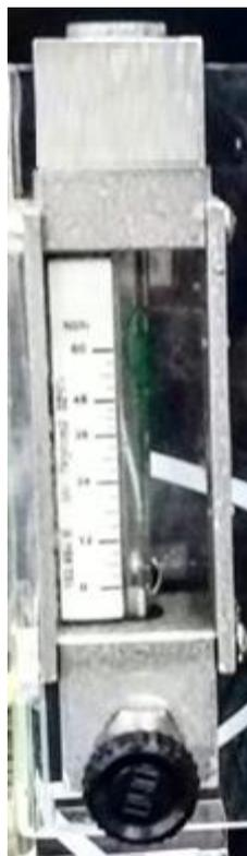
**Figura 10 - Rotômetro com fundo de escala 60 NL/h**
