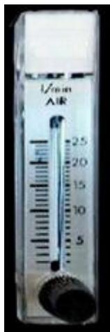
Figura 30- Rotômetro com fundo de escala 25 NL/min.
