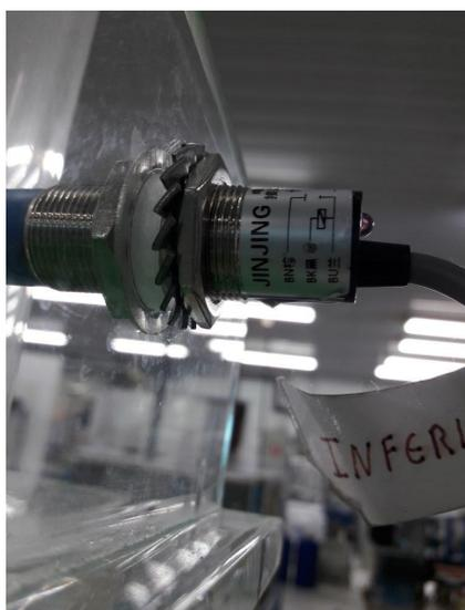
Figura 34- Sensor Capacitivo metálico com rosca faceado
