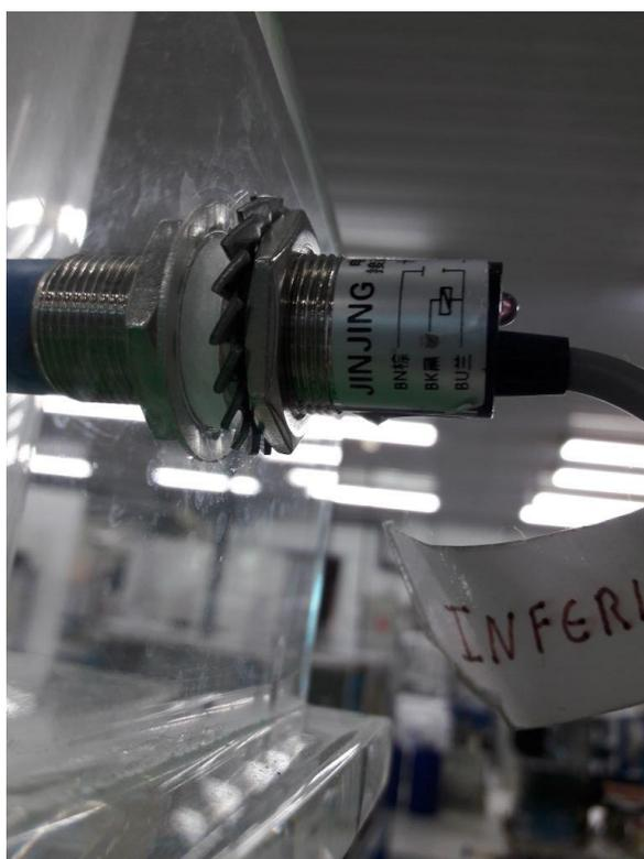
Figura 13 - Sensor Capacitivo no medidor torre
