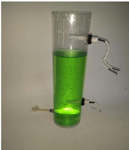
**Figura 12 - Dispositivo para teste do sensor de nível**
