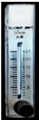
**Figura 11 - Rotâmetro com fundo de escala 25 NL/min**
