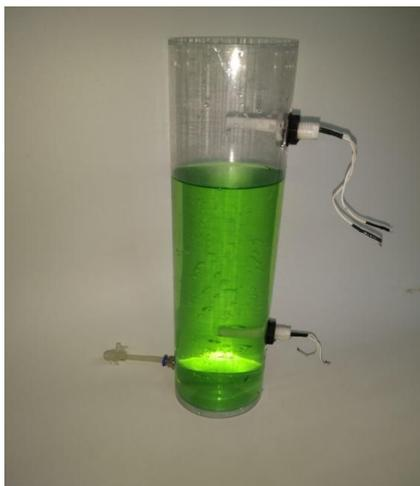
Figura 33- Dispositivo para teste do sensor de nível
