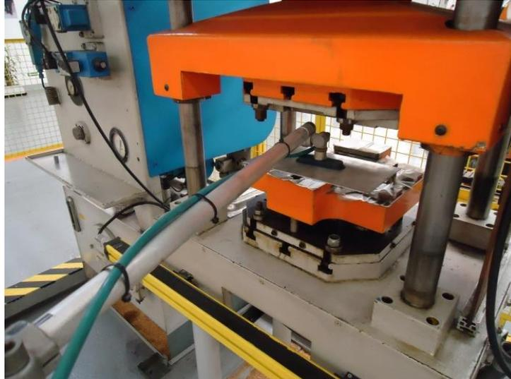
**Figura 13. Robô 1 posiciona a chapa dentro do estampo.**
