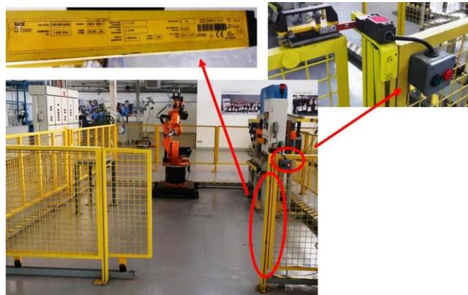
**Figura 8. Configuração dos itens de segurança da célula 1.**
