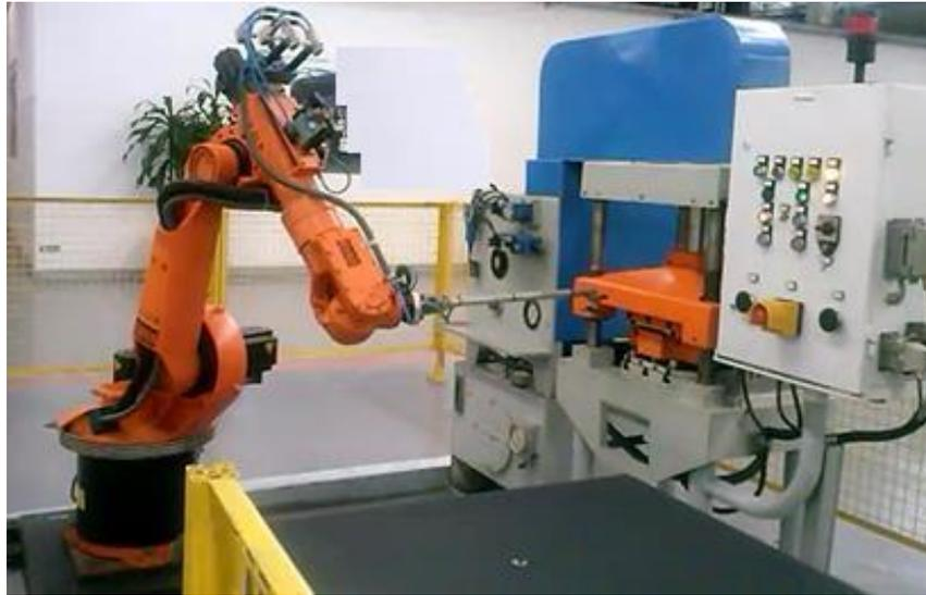
**Figura 15. Estampo fechado para conformação final da peça.**
