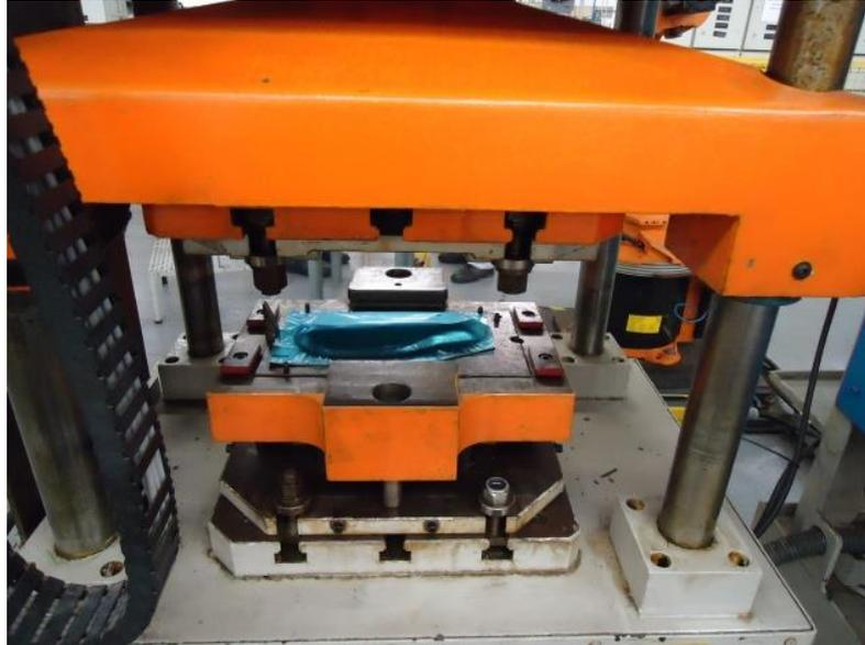
**Figura 16. Estampo aberto com peça finalizada aguardando para ser retirada.**
