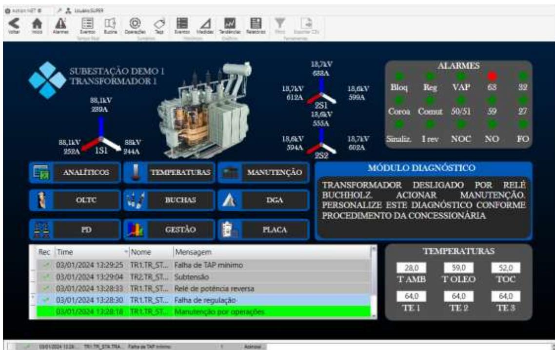
Figura 13. Tela principal do transformador com atalhos e módulo diagnóstico.
