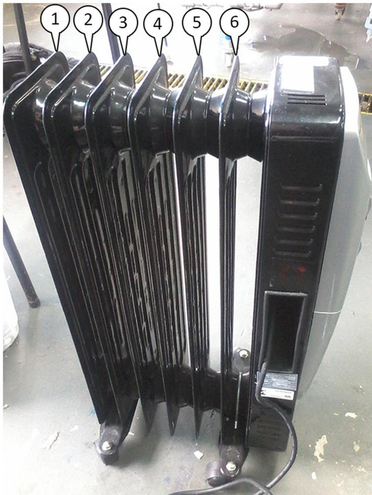
**Figura 2.5 – Numeração das aletas do aquecedor.**
