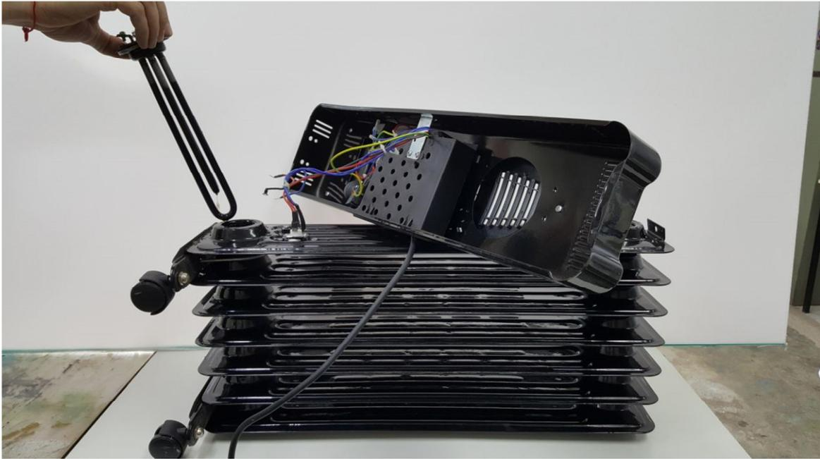
**Figura 2.6 – Aquecedor desmontado.**
