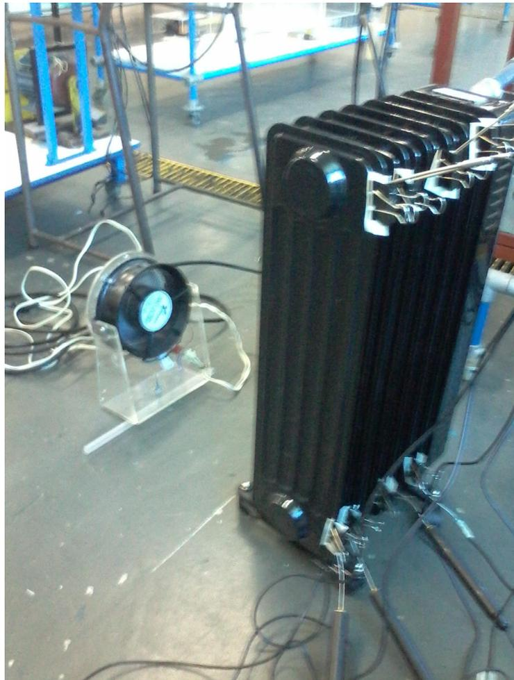
**Figura 2.32 – Experimento com convecção forçada.**
