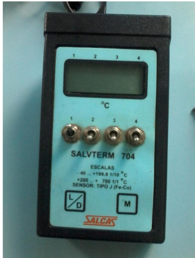
Figura 2.7 - Sensor de termopar modelo Salvterm 704.
