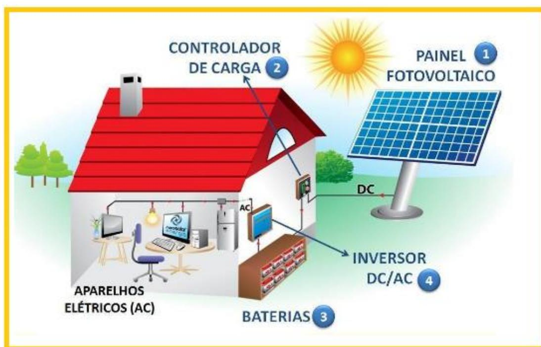
**Figura 8 - Sistema isolado ou autônomo: 1) Painel Fotovoltaico; 2) Controlador de Carga; 3) Baterias; 4) Inversor DC/AC.**
