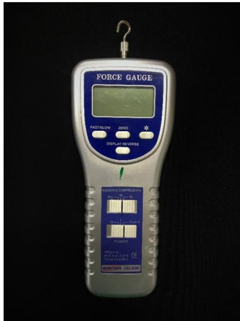
Figura 26: Dinamômetro de marca Instrutherm, modelo DD-500.
