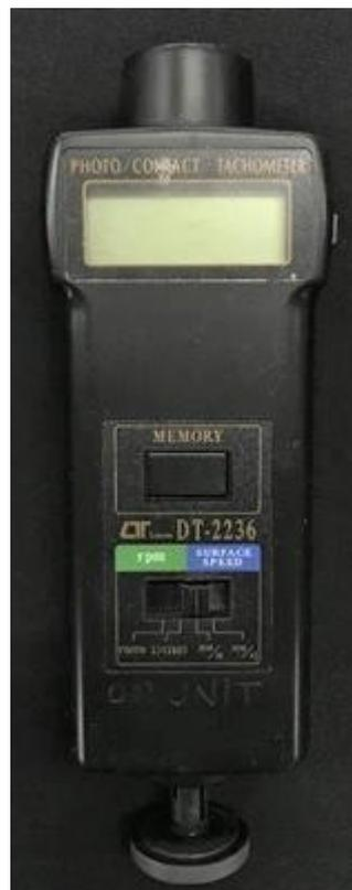
Figura 27: Tacômetro de marca Lutron, modelo DT 2236 e capacidade máxima de 100.000 rpm.
