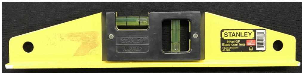
Figura 29: Régua de nível de marca Stanley e base com ímã.
