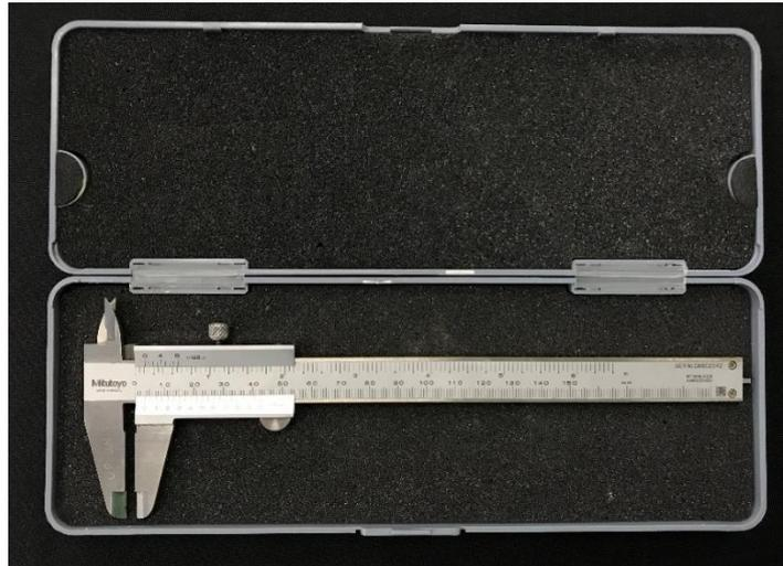
Figura 28: Paquímetro de marca Mitutoyo de 150 mm.
