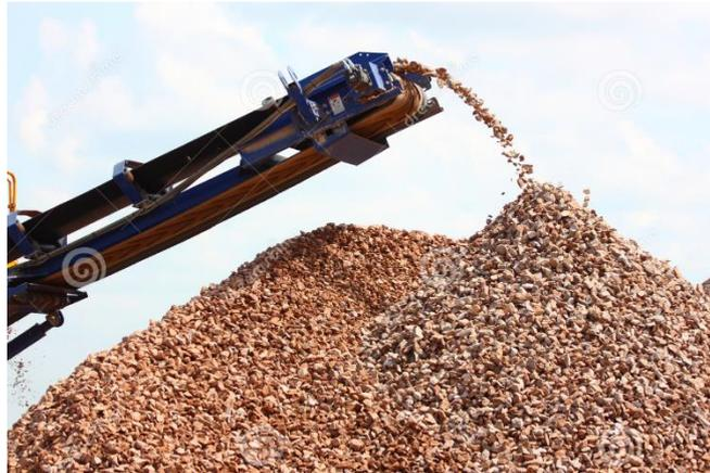
Figura 4: Ponto de descarga de uma correia transportadora.
