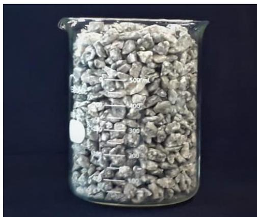
Figura 20: Amostra geral de brita zero.
