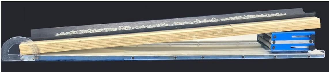
Figura 35: Bancada experimental para ensaio de escorregamento das britas em borracha estática, com elevação dada pelo suporte elevador.
