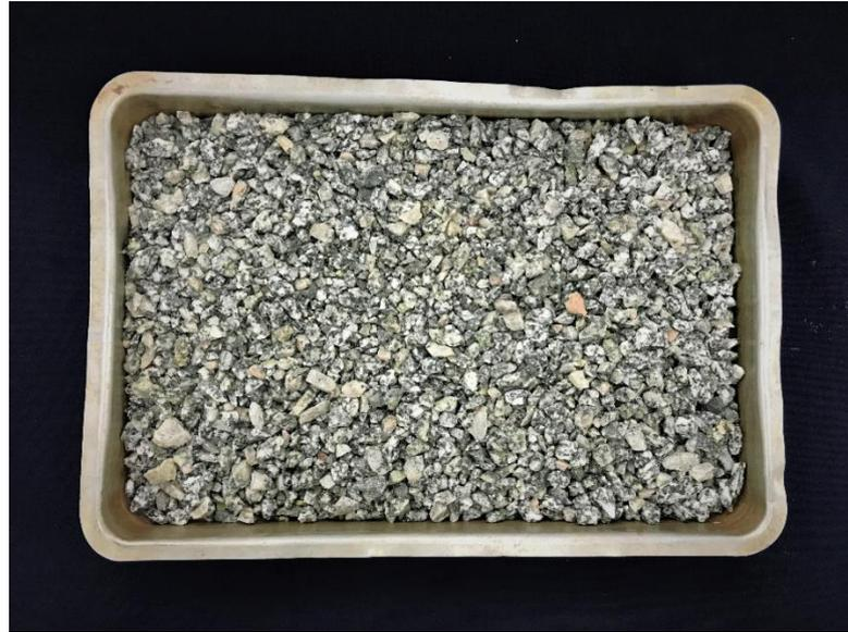
Figura 21: Amostra de brita zero em bandeja para secagem.
