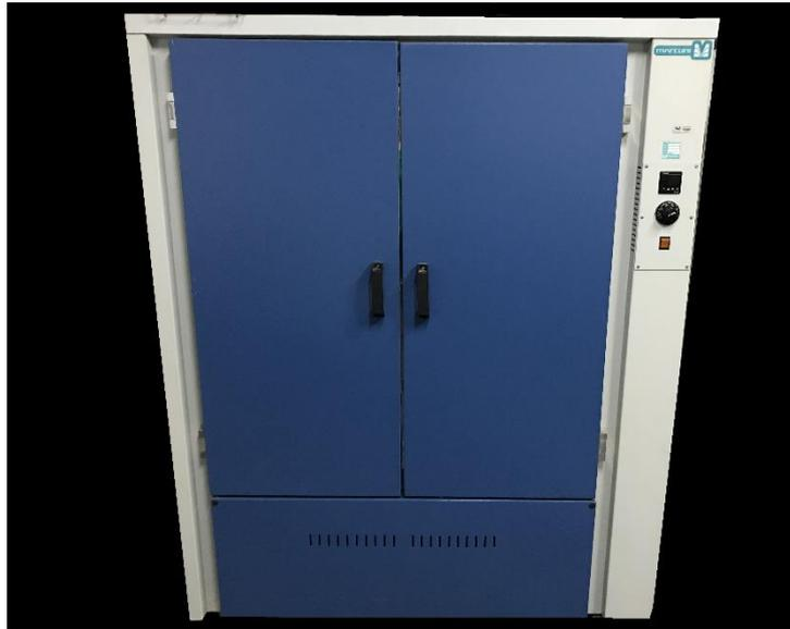
Figura 24: Estufa de marca Marconi, modelo MA 035/630i de 4.500 Watts
