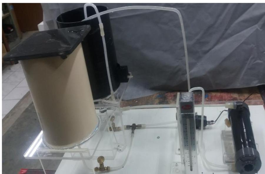
Figura 13 - Protótipo do sistema de Fotólise com reator na horizontal.
