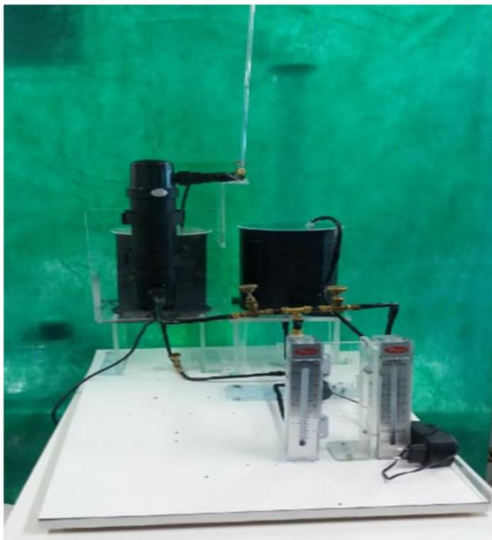
**Figura 15 - Protótipo final do sistema de Fotólise**
