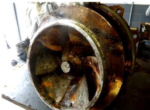
**Figura 31** – Vista frontal interna de rotor da bomba B-2644.
