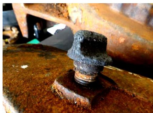
**Figura 32** – Dispositivo de respiro com queimadura na bomba B-2644.
