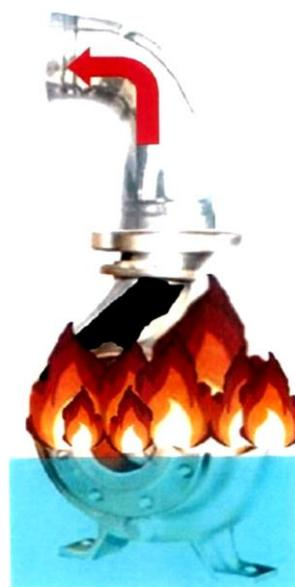
**Figura 39** – Projeção de região na bomba B-2678 afetada pelo incêndio.
