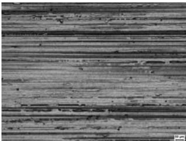
**Figura 23 - Amostra retificada cromada, vista superior com aumento de 100X.**
