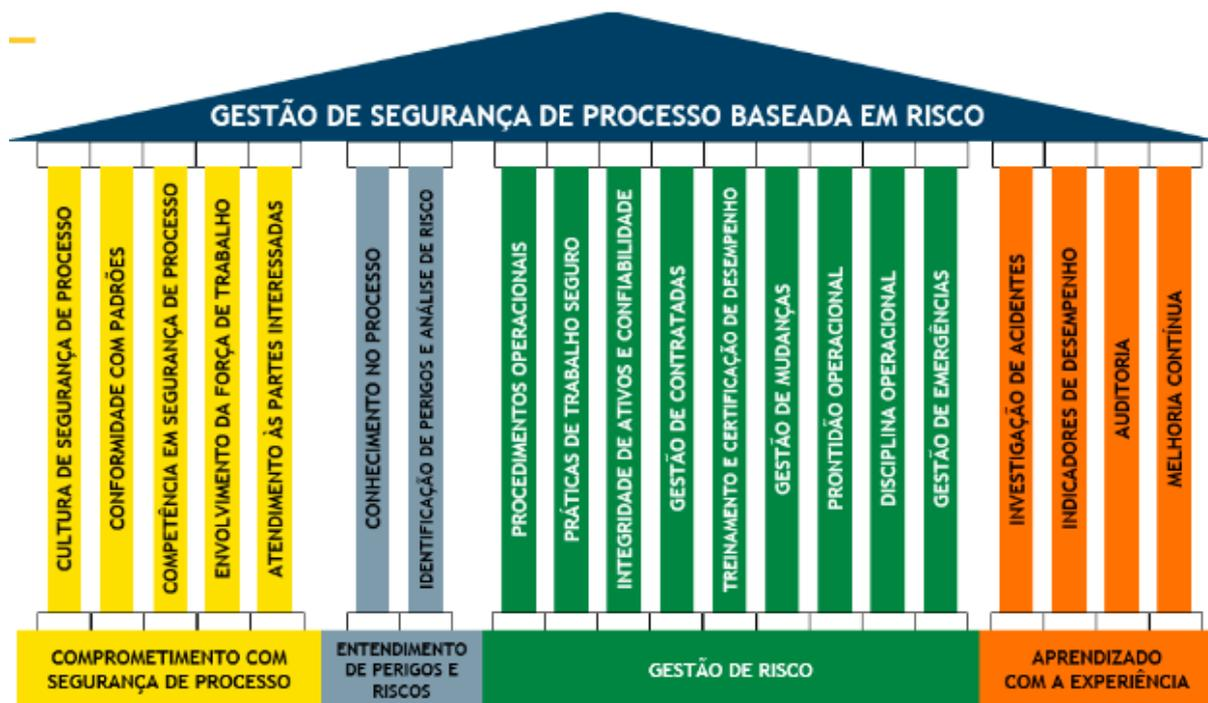
**Figura 7: Elementos de Segurança de Processo Baseada em Risco (RBPS)**
