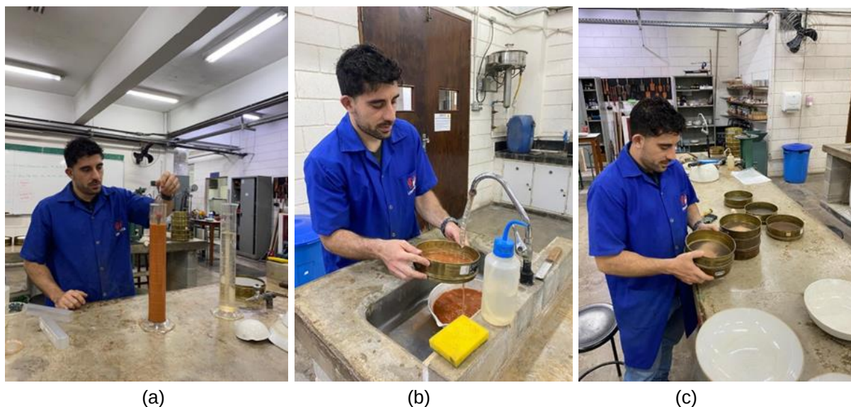
Figura 9. Análise granulométrica Solo 1 – (a) Sedimentação. (b) Lavagem. (c) Peneiramento fino. Fonte: Elaborada pelo autor.
