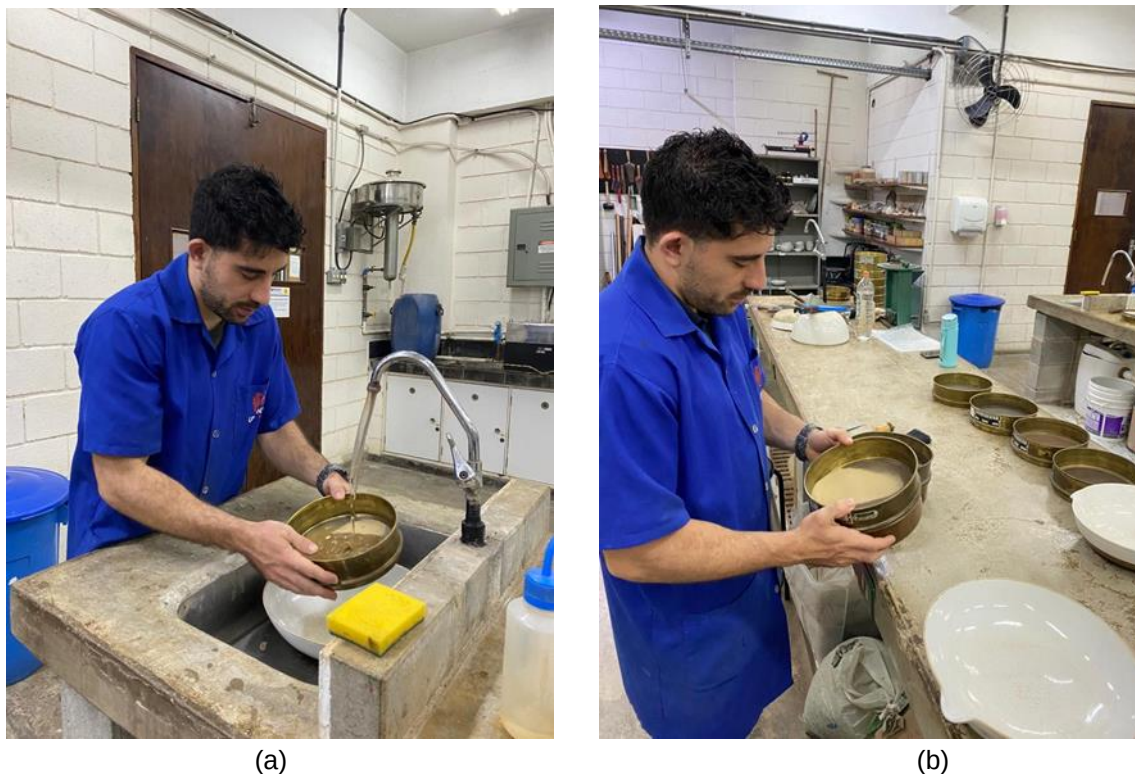
Figura 10. Análise granulométrica Solo 2 – (a) Lavagem. (b) Peneiramento fino. Fonte: Elaborada pelo autor.
