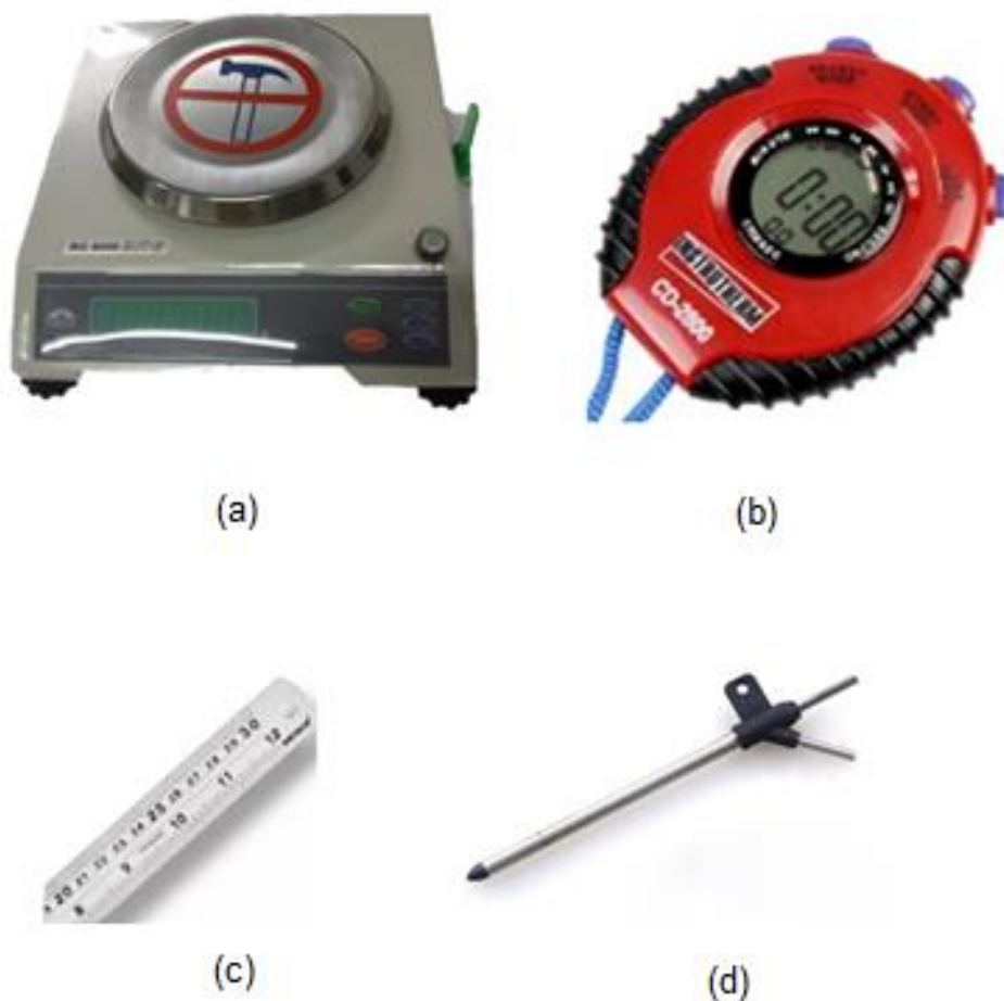
Figura 20 - Instrumentos auxiliares de medida: (a) Balança Gehaka Modelo Bg 8000 (carga máxima de 8.080 g); (b) Cronometro Digital Instrutherm Modelo CD 2800; (c) Escala Graduada (comprimento igual a 30 cm) e; (d) Tubo Pitot aeromodelo.
